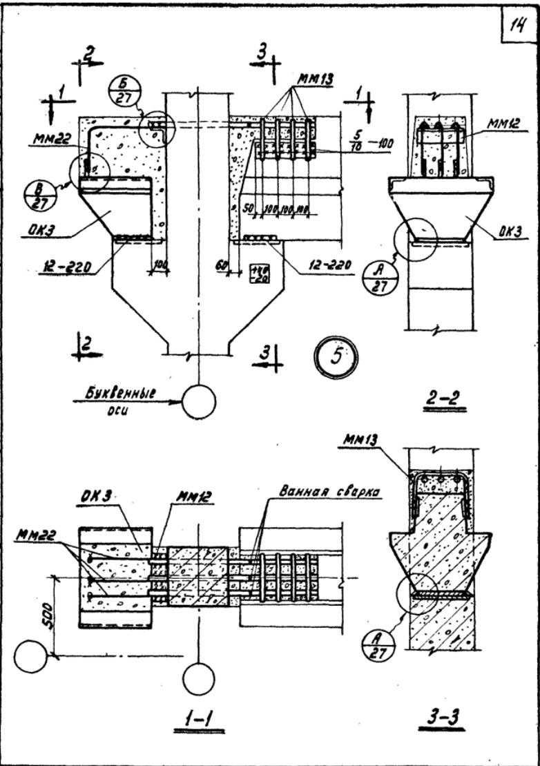
**ТДМ** 1967г. Деталь сопряжения ригеля перекрытия и опорной консоли у торцов и температурных швов с крайней колонной **ТДМЭ22-1** Деталь 5
