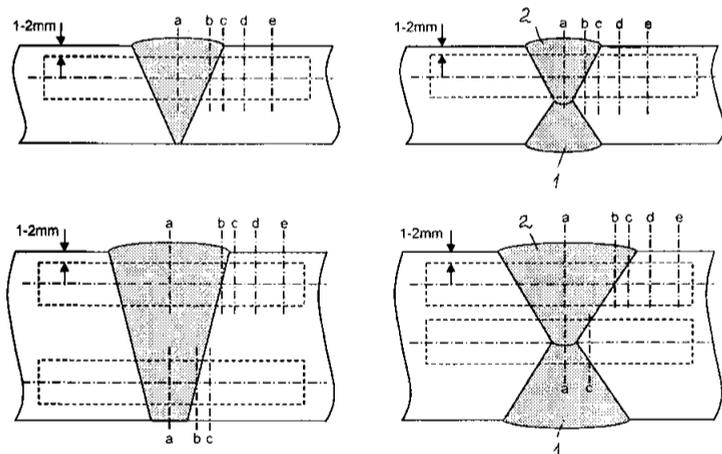
Рис. 6.4.5.1-2 Схема вырезки и расположения надреза на образцах для испытаний на ударный изгиб при одобрении технологических процессов сварки с погонной энергией свыше 50 кДж/см:
