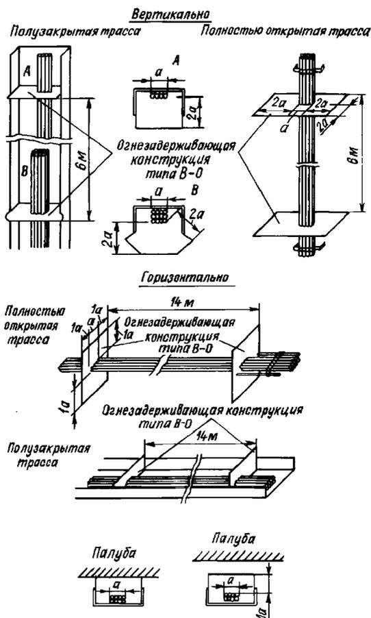
Рис. 16.8.4.3-3 Защита кабельных трасс огнезадерживающими конструкциями типа В-0
