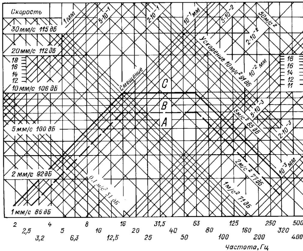
Рис. 9.7.1 Нормы вибрации котлов, вспомогательных механизмов и оборудования:
