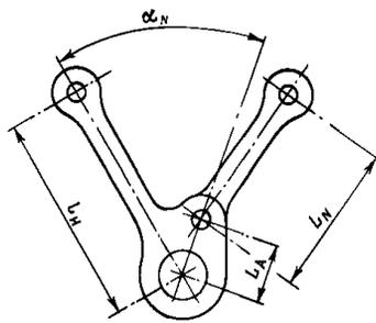
Рис. 2.4.3-2 Прицепной шатун
