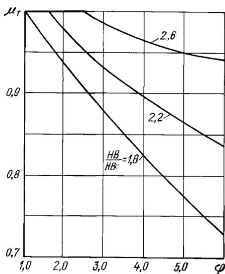
Рис. 4.2.2.8 График для определения коэффициента  $\mu\tau$  в зависимости от  $\phi$  и  $HV/HV_c$
