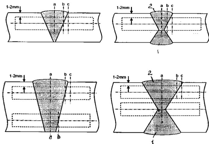
Рис. 6.4.5.1-1 Схема вырезки и расположения надреза на образцах для испытаний на ударный изгиб при одобрении технологических процессов сварки с погонной энергией до 50 кДж/см вкл.:
