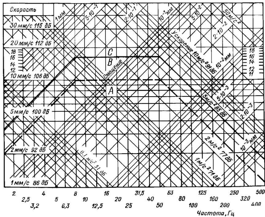
Рис. 9.6.1 Нормы вибрации поршневых компрессоров:
