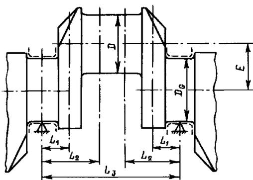
Рис. 2.4.4.1-2 Кривошип двигателя с двумя шатунами
