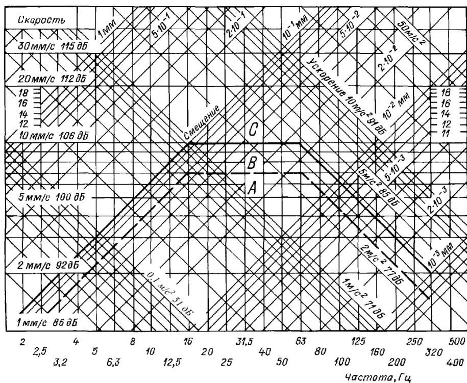
Рис. 9.5.1 Нормы вибрации насосов мощностью 15 — 75 кВт:
