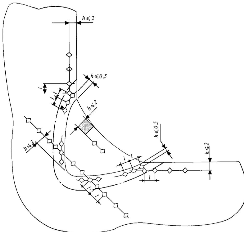
Рис. 6.4.6-4 Схема расположения точек замеров твердости в околошовной зоне и шве для тавровых соединений, выполненных однопроходным угловым швом без разделки кромок (ограничения по  $l$  согласно рис. 6.4.6-2)
