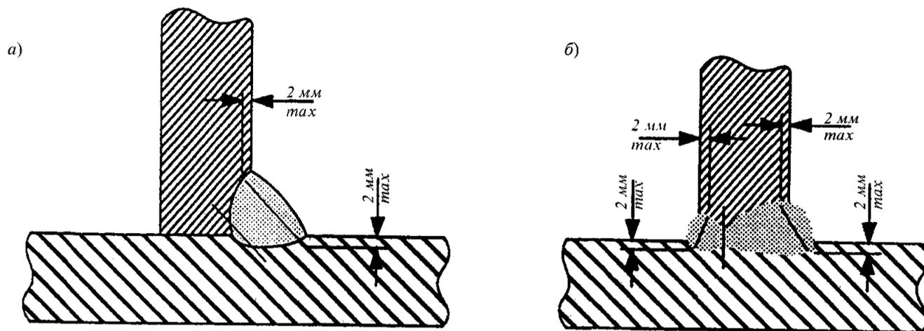
Рис. 6.4.6-3 Схема расположения линий замеров твердости для проб тавровых соединений:
