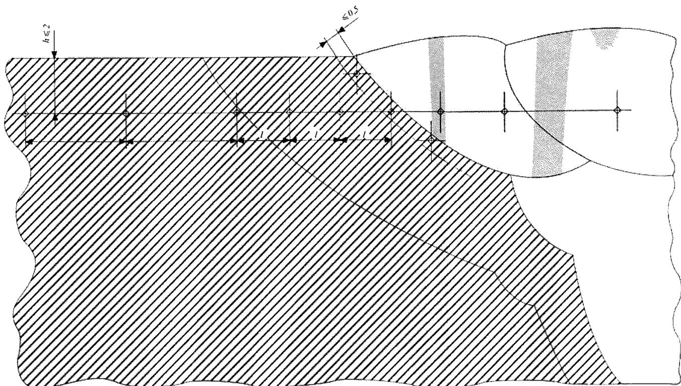
Рис. 6.4.6-2 Схема расположения точек замеров твердости в околошовной зоне и шве для стыкового сварного соединения:
