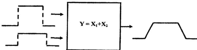
**Рис. 3** Плотность распределения вероятностей суммы двух независимых равномерно распределенных величин  $X_1$  и  $X_2$
