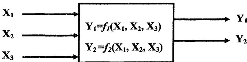
**Рис.5 Измерительная функция с тремя исходными величинами  $X_1$ ,  $X_2$  и  $X_3$  и двумя выходными величинами  $Y_1$  и  $Y_2$**
