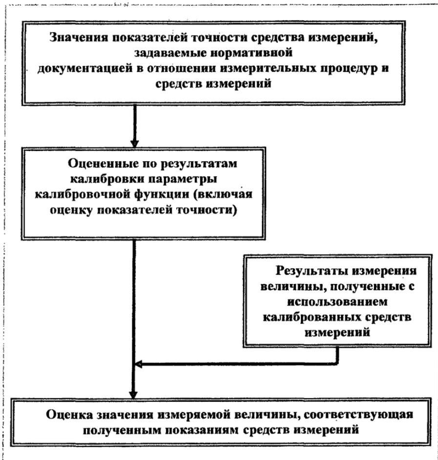
**Рис.6 Двухэтапная измерительная модель получения калибровочной функции, где величины, определяемые нормативными документами, и соответствующие показания средств измерений используются для определения оценочных значений параметров калибровочной функции, которые, с учетом последующих показаний, применяются для оценки значения измеряемой величины**
