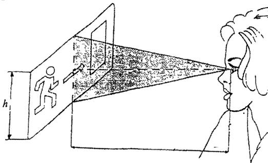
Рисунок В.2 — Определение расстояния различения знака безопасности
