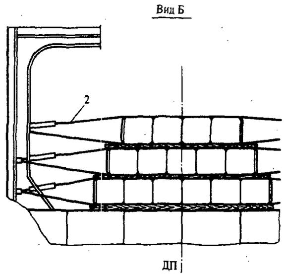
Рис. П.7.2. Схема крепления штабеля слитков:
