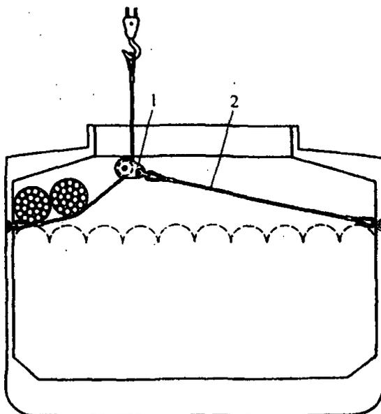
Рис. 2.1.4. Схема применения канифас - блоков при использовании штивующих стропов:
