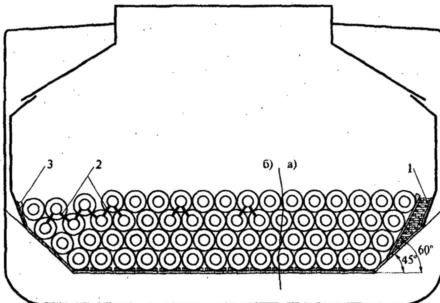
Рис. 2.4.4. Схема укладки и крепления рулонов в трюмах балкеров
