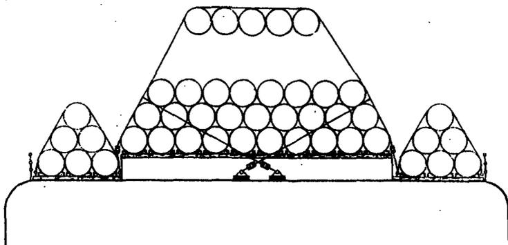
Рис. 2.2.1. Укладка труб отдельными штабелями
