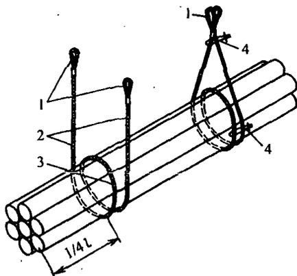
Рис. 2.1.2. Схема формирования УГМ труб малого диаметра в инвентарных стропях способом двойного охвата:
