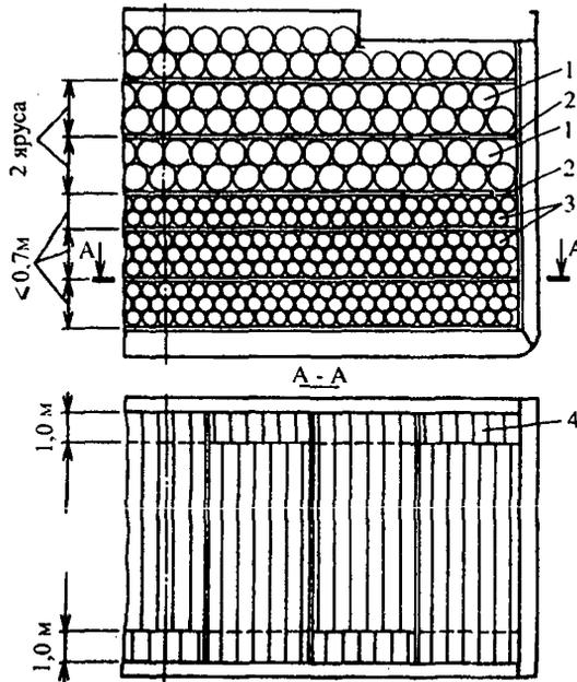
Рис 2.1.1. Схема размещения труб малого диаметра перегружаемых поштучно:
