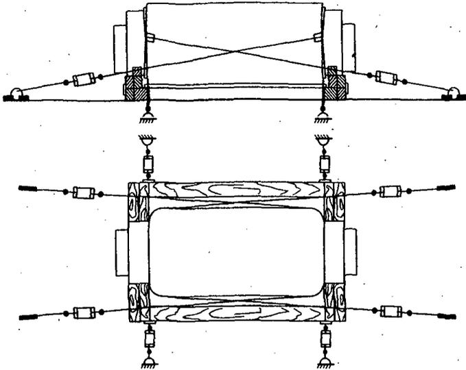
Рис. 2.16.1. Схема крепления вала
