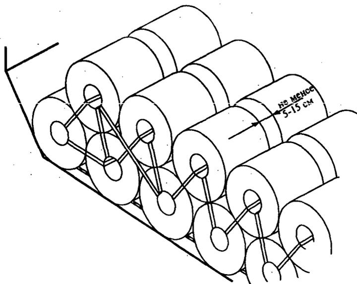
Рис. 2.4.5. Схема крепления рулонов, не имеющих опоры на борта
