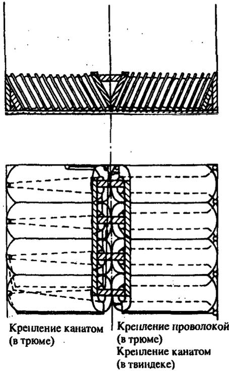
Рис. 2.17.1. Размещение и крепление бандажей (колес)
