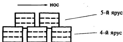
Рис. 2.4.6. Схема установки рулонов 5-го яруса с опорой на рулоны 4-го яруса
