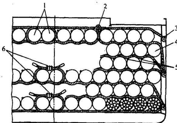
Рис. 2.1.3. Укладка и крепление УГМ с трубами малого диаметра с применением штивующих стропов:
