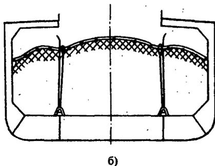
Рис. П.6.1. Способ предотвращения смещения упругодеформируемых навалочных грузов в трюме судна
