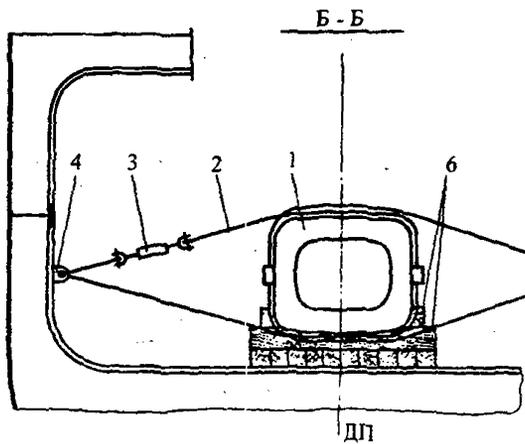
Рис. П.8.1. Размещение и крепление изложниц, укладываемых плашмя:
