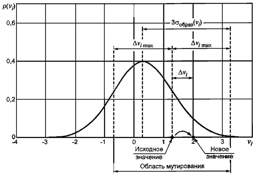
Рисунок 2 — Мутация параметра  $v_i$  при синтезе биометрического примера
