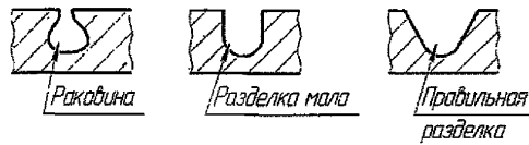
Рисунок 2 – Формы разделки под заварку несквозных дефектов
