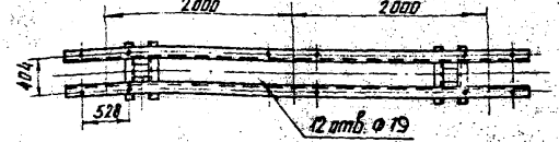
Разметка отверстий для крепления трансформатора напряжения М1:50
