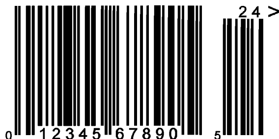
Рисунок 5 — Символ штрихового кода UPC-A с 2-разрядным дополнительным символом
