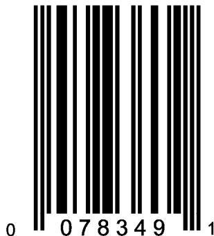
Рисунок 4 — Символ штрихового кода UPC-E (кодирующий "0 07834 00009 1" с отбрасыванием незначущих нулей)
