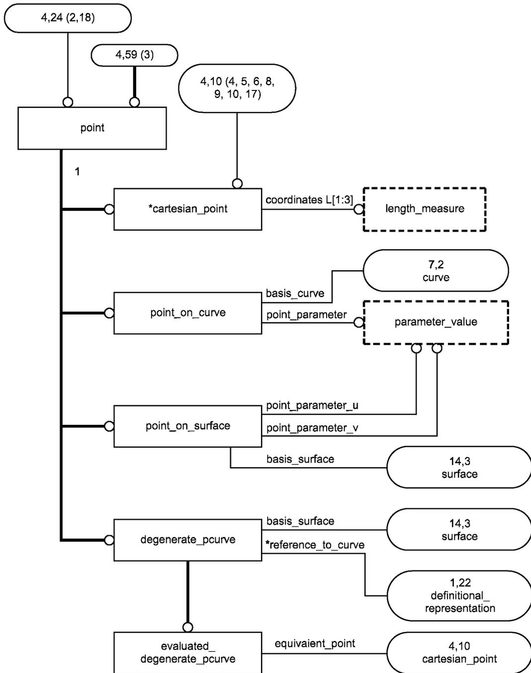
Рисунок С.4 — ПИК `non_manifold_surface_shape_representation` в формате EXPRESS-G
