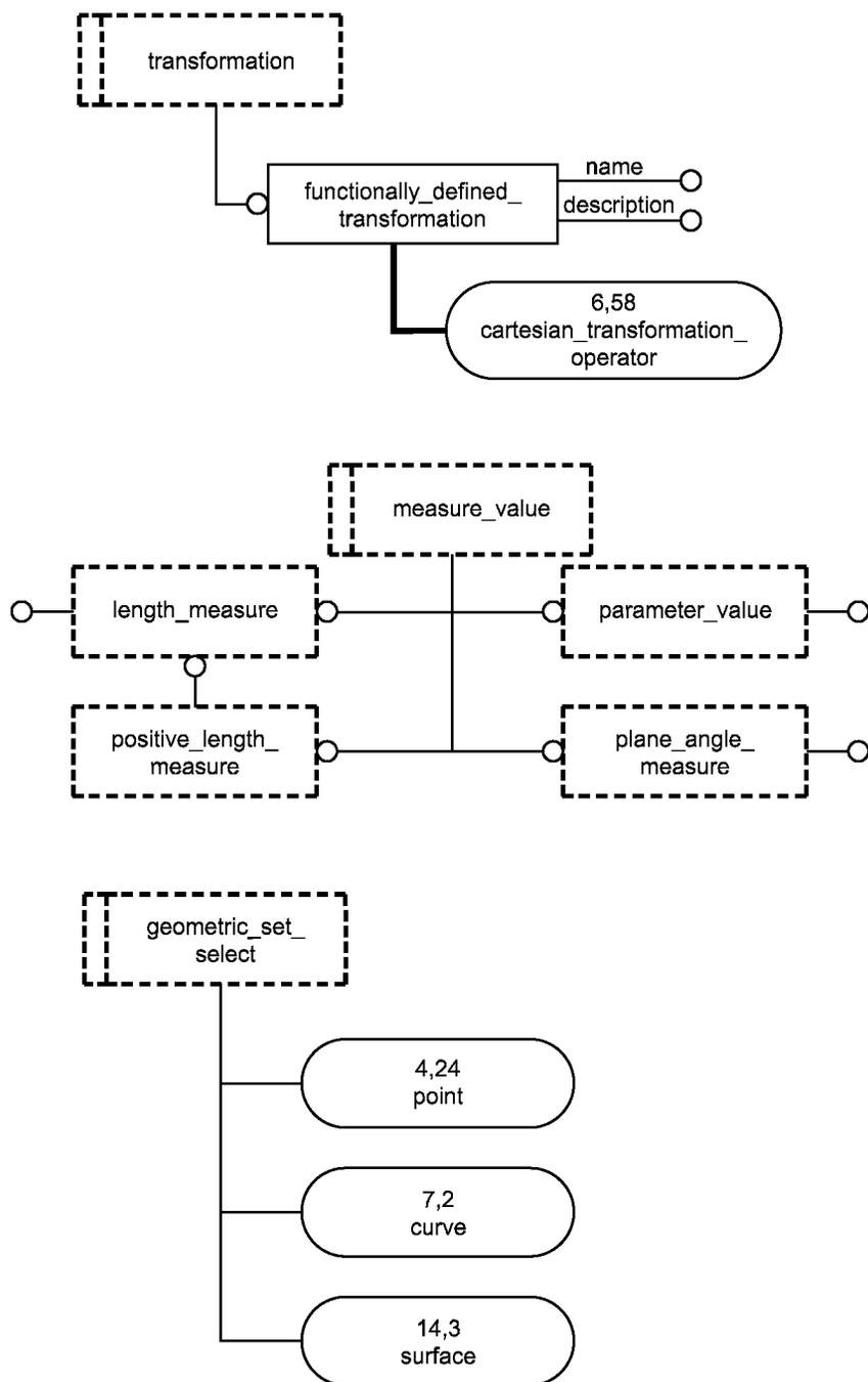
Рисунок С.2 — ПИК `non_manifold_surface_shape_representation` в формате EXPRESS-G
