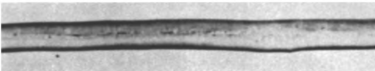
Рисунок 3 — Нормальное волокно (стержнеобразный вид, просвет может быть виден неотчетливо в некоторых местах, но не на всем протяжении волокна)
