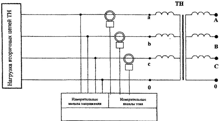
Рисунок 1 – Схема выполнения измерений мощности нагрузки трехфазного ТН
