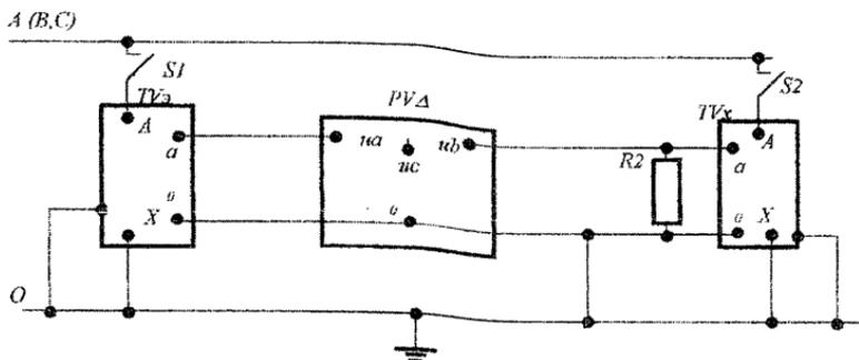
$A(B,C)$  - фазы напряжения;  $TV_x$  - проверяемый трансформатор;  $TVЭ$  - эталонный трансформатор;  $A$  - высоковольтный вывод трансформатора;  $X$  - вывод заземления;  $a$  - низковольтный вывод трансформатора;  $o$  - нулевой вывод трансформатора и прибора сравнения;  $ia, ib, ic$  - входные клеммы прибора сравнения;  $S1$  - выключатель свободной ячейки,  $S2$  - выключатель рабочей ячейки;  $PVD$  - прибор сравнения;  $R_2$  - нагрузка проверяемого трансформатора;
