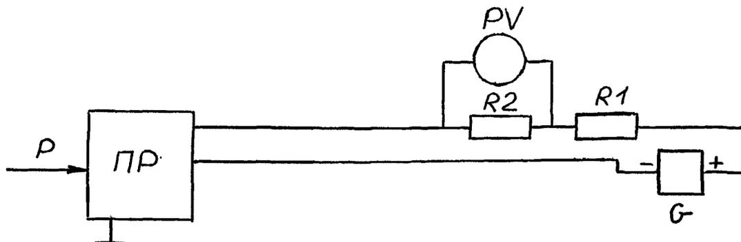
Схема включения преобразователя с аналоговым выходным сигналом (4...20) мА при измерении выходного сигнала по току
