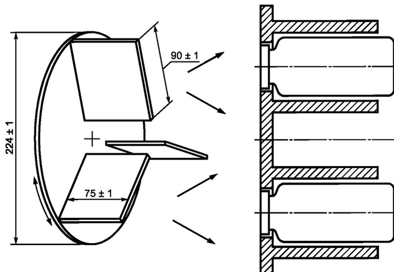
Рисунок 1 — Общая схема машины для испытания
