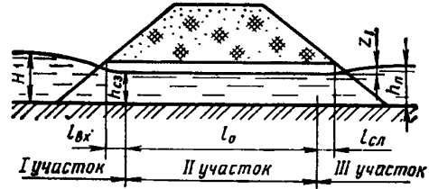
Рис. 5.11. Схема протекания воды по трубе, затопленной с нижнего бьефа
