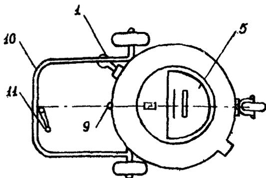
Схема заливщика швов для битумной мастики: 1 - паяльная лампа; 2 - эжекционный патрубок; 3 - теплоизолированный наружный кожух; 4 - емкость для разогретой мастики; 5 - крышка емкости; 6 - выходной патрубок; 7 - сетка; 8 - клапан; 9 - сливной патрубок; 10 - ручка; 11 - рукоятка управления клапаном
