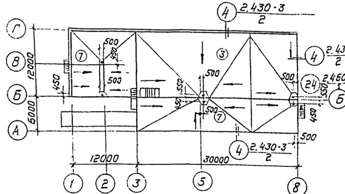
Уклон кровли принять 05%
