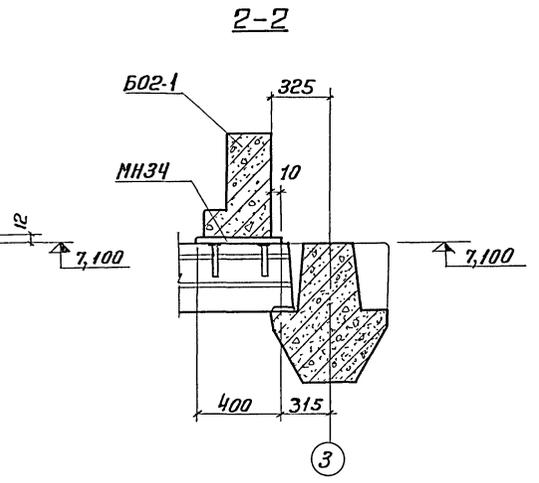
1. Швы приварки монтажных марок ММ2, ММ4 к закладным деталям колонн и балок должны быть защищены цинковым покрытием в соответствии с СНи П П-28-13
