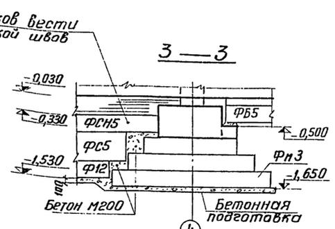
1. Под фундаменты выполнить бетонную подготовку из бетона М50 толщ. 100мм, превышающую заборит подошвы ф-тов на 100мм в каждую сторону.
