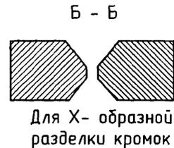
Для строганных по периметру обечаек на привариваемых к обечайке планках (образце-свидетеле) снять фаску газовым резаком
