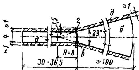
Рис. 6. План места для метания копья (размеры в м)
