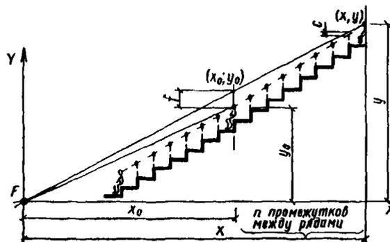
Рис. 1. Профиль зрительских мест по отрезкам ломаной линии
