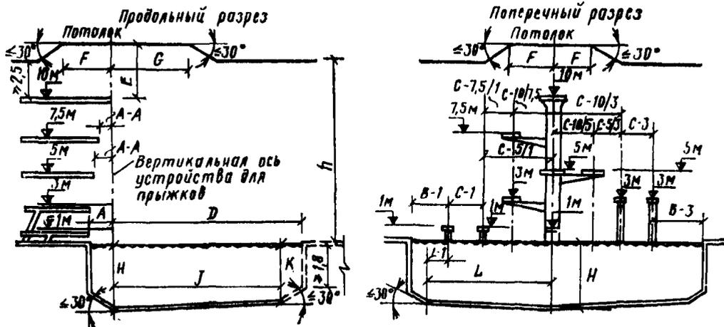
Рис. 12. Состав и размеры устройств для прыжков в воду, требования к высоте залов и размерам ванны для прыжков
