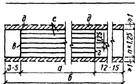
Рис. 8. План прямой легкоатлетической беговой дорожки (размеры в м)
