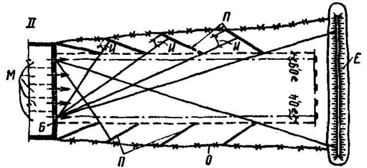
Рис. 22. Схемы определения размеров, местоположения и количества перехватов в огневых зонах полуоткрытых тиров (размеры в м)
