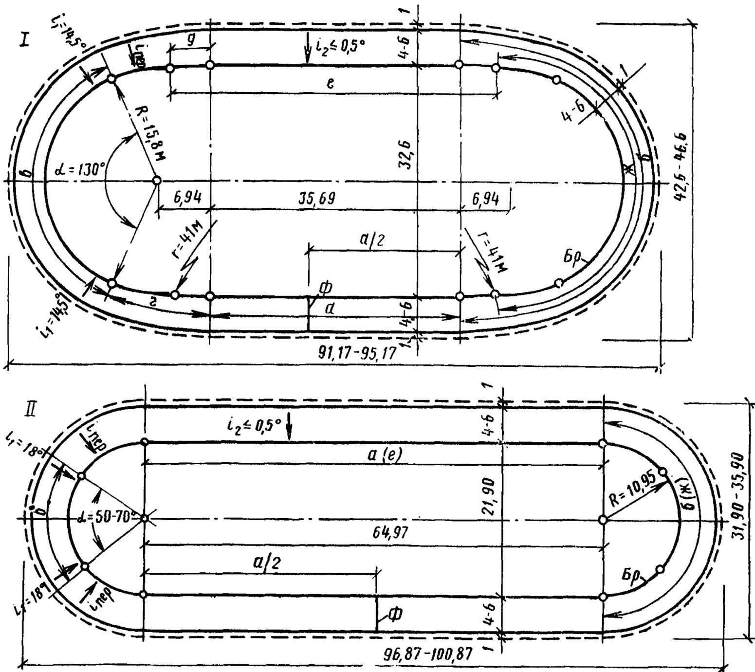
Рис. 10. План-схема круговой беговой легкоатлетической дорожки оптимальной расчетной длины 200 м в зале (манеже) (размеры в м)
