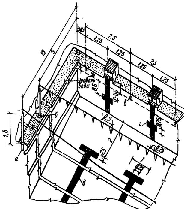
Рис. 17. Размещение закладных устройств и разметка ванны для спортивного плавания (размеры в м)
