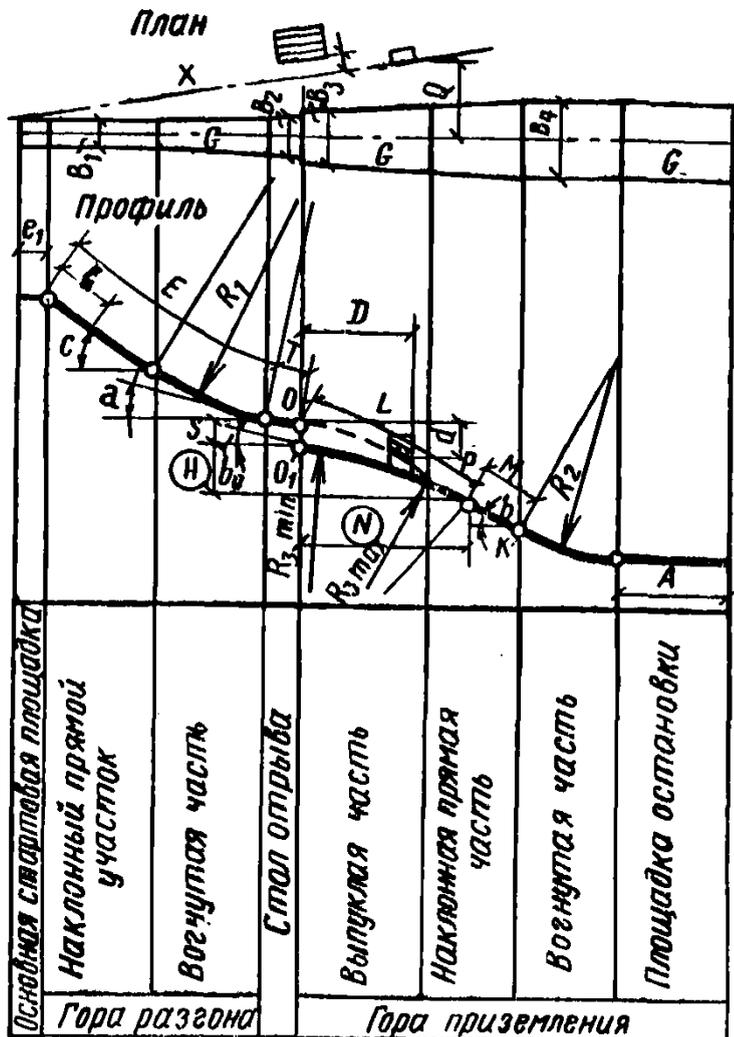
Рис. 1. Схема трамплина для прыжков на лыжах
