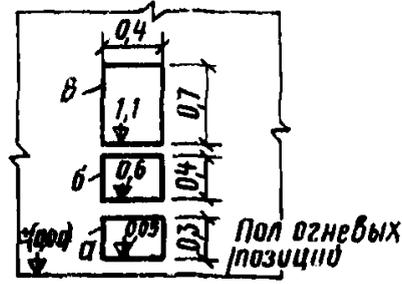
Рис. 21. Схема расположения и габариты бойниц (размеры в м)
