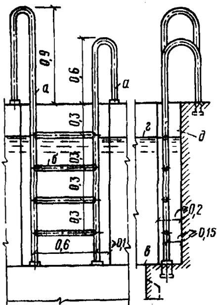
Рис. 16. Схема лестницы для выхода из ванны (размеры в м)
