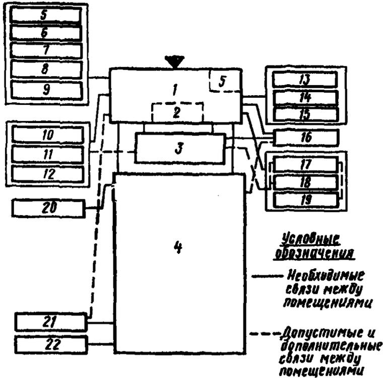
Рис. 20. Схема взаимосвязей вспомогательных помещений между собой и с основными помещениями и сооружениями отдельно стоящих крытого и полуоткрытого тиров
