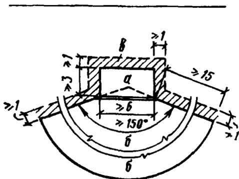
Рис. 2. План места для прыжков в высоту (размеры в м)
