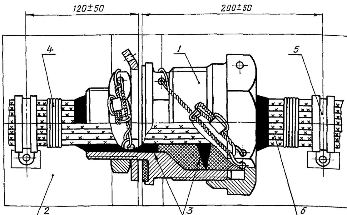
1 - ввод по ОСТ 1 11743-74; 2 - ударный (вибро) стенд; 3 - герметик Виксинт У-2-28НТ по ОСТ 38.03238-81; 4 - бандаж по ОСТ 1 03856-79; 5 - хомут; 6 - жгут
