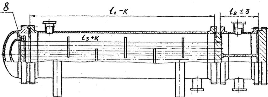
1-кожух; 2-распределительная камера; 3-крышка; 4-перегородка поперечная; 5-перегородка продольная; 6-трубная решетка; 7-опора; 8-плавающая головка.
