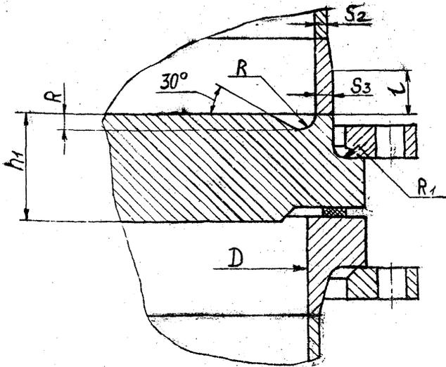
$$S_3 \geq \max \left\{ \begin{array}{l} S_3 \\ 2S_{2p} + C \\ S_2 \end{array} \right\} \quad \begin{array}{l} \text{но не} \\ \text{менее} \end{array} \quad \left\{ \begin{array}{l} 20 \text{ мм при } D > 1000 \text{ мм;} \\ 16 \text{ мм при } 600 \leq D \leq 1000 \text{ мм;} \\ 12 \text{ мм при } D < 600 \text{ мм;} \end{array} \right\}$$
