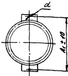
При четырех опорах для корпусов диаметрами 1000...1400 мм и диаметрами 600, 800 мм при  $l > 2000$  мм
