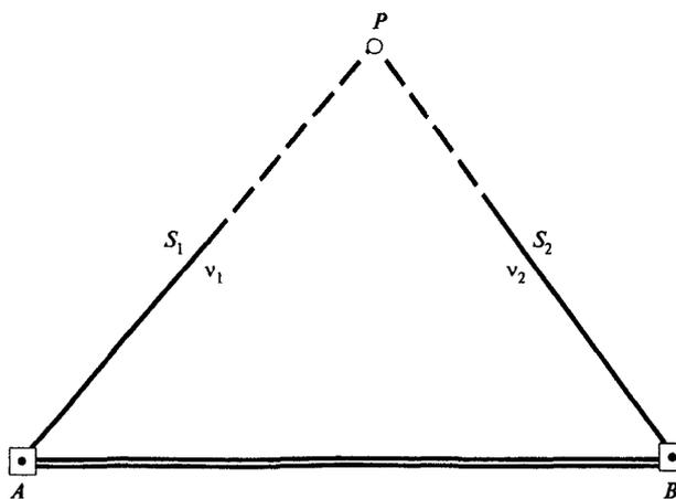
Рис. 2.3. Схема способа линейной засечки
