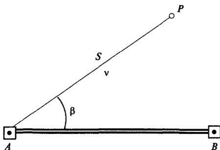
Рис. 2.1. Схема способа полярных координат
