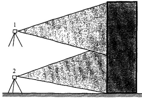
*Рисунок 10.1. Съёмка объекта с вертикальным базисом*
