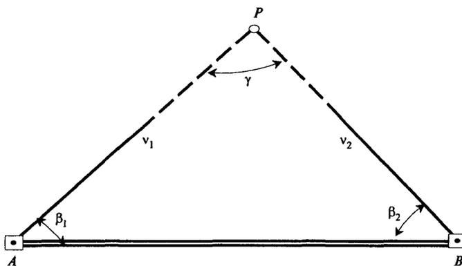
Рис. 2.2. Схема способа прямой угловой засечки
