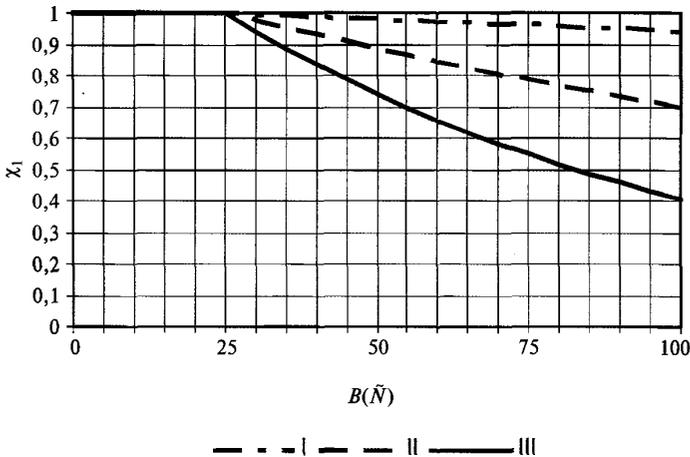
Рис. В.2. Графики нормированных функций  $\chi_1(B)$ ,  $B$ , м — наименьший размер сооружения в плане
