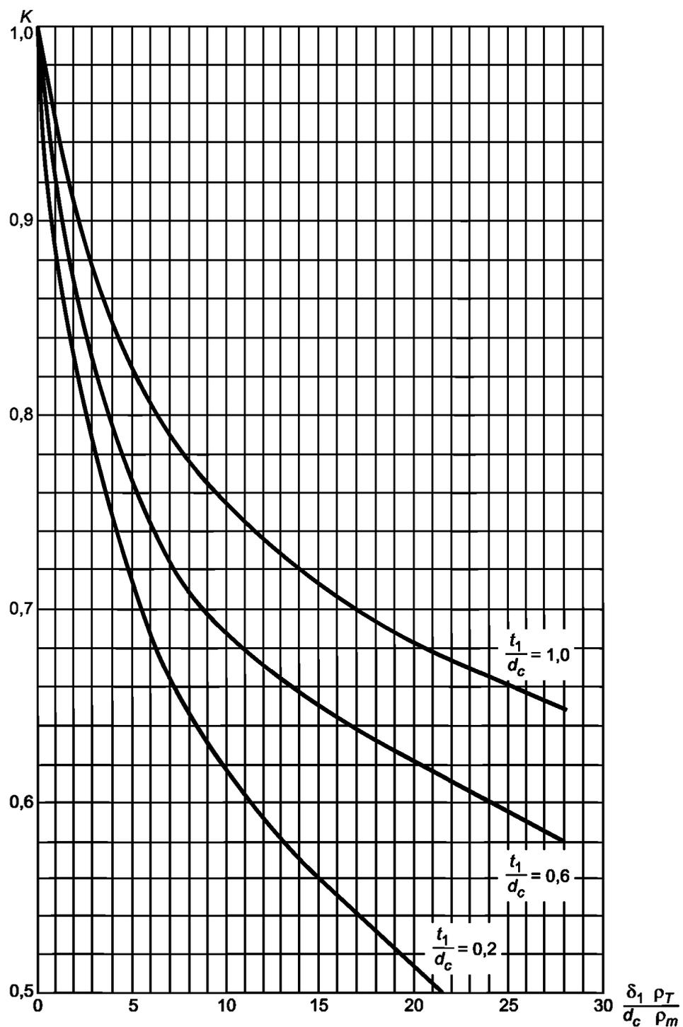
$K$  — коэффициент экранирования;  $\delta_1$  — толщина металлического экрана по изолированной жиле;  $\rho_T$  — удельное тепловое сопротивление изоляции;  $d_c$  — диаметр жилы (круглой);  $t_1$  — толщина изоляции между жилой и экраном;  $\rho_m$  — удельное тепловое сопротивление экранирующего материала:
