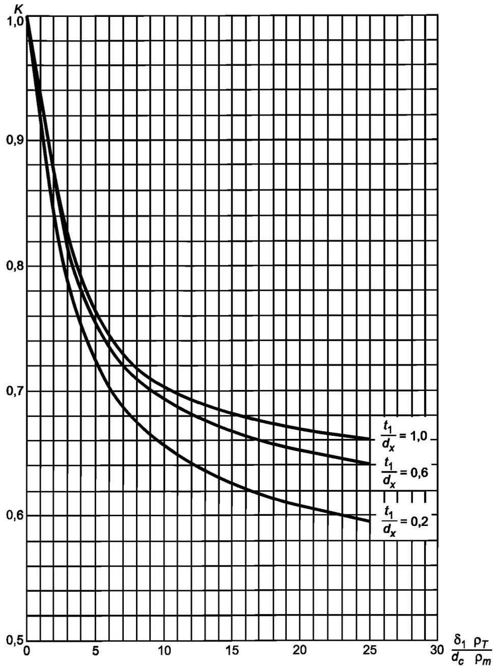
$K$  — коэффициент экранирования;  $\delta_1$  — толщина экрана;  $\rho_T$  — удельное тепловое сопротивление изоляции;  $d_x$  — диаметр круглой жилы, имеющей ту же площадь сечения и степень уплотнения;  $t_1$  — толщина изоляции между жилой и экраном;  $\rho_m$  — удельное тепловое сопротивление экранирующего материала:
