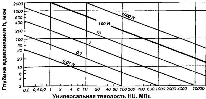
Рисунок В.3 – Номограмма определения универсальной твердости
