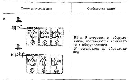
Примечания: 1. Местоположение не встроенных в оборудование пусковых отключающих аппаратов определяется по согласованию с технологами. 2. Присоединение электроприемников в цепочку осуществляется без разрыва проводов. 3. Обозначения даны в приложении 2.
