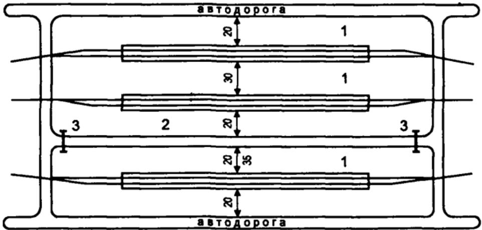
*Схема размещения пожарных проездов
