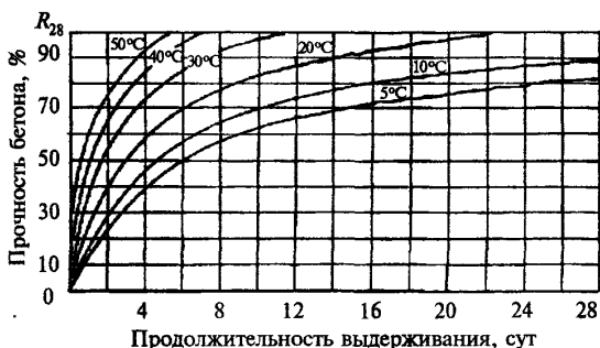
Рисунок 7 — Прочность бетона в зависимости от температуры и продолжительности выдерживания
