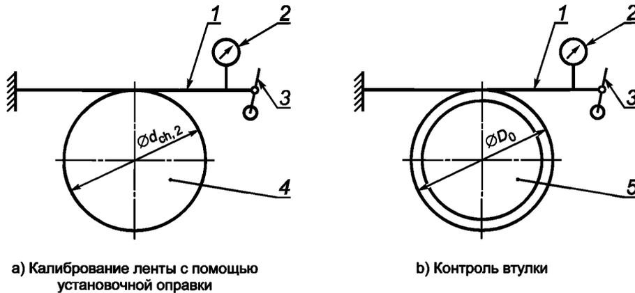
1 — прецизионная мерная лента; 2 — измерительный прибор; 3 — механизм натяжения; 4 — установочная оправка;
