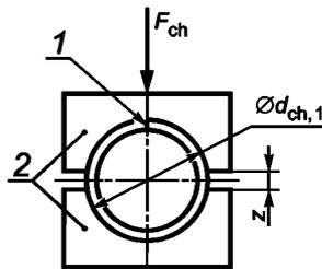
1 — положение разреза; 2 — контрольный блок
