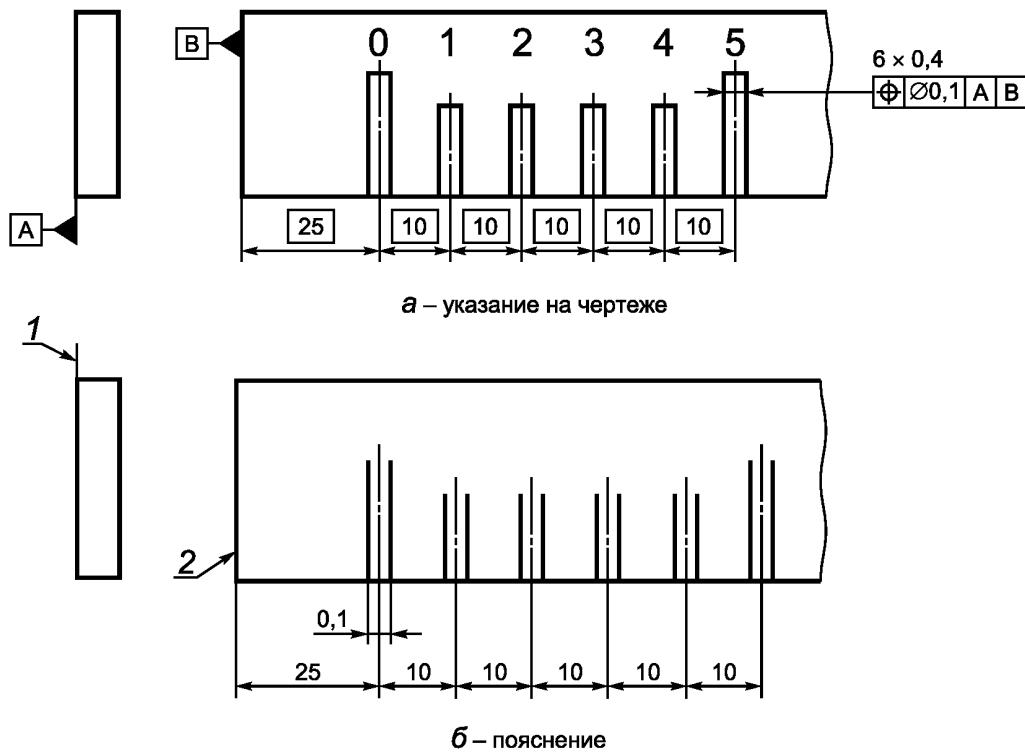
1 — моделированная база А; 2 — моделированная база В
