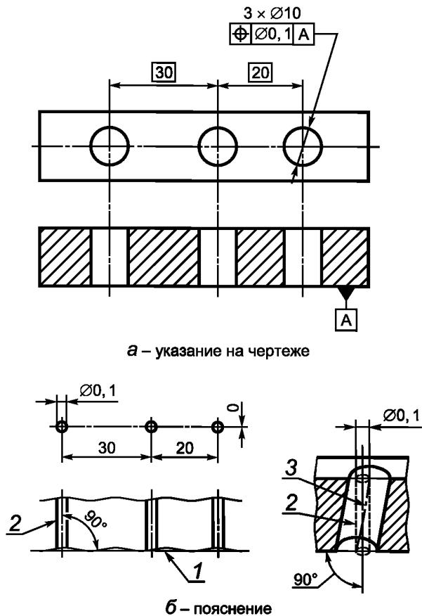
1 — моделированная база А; 2 — поле допуска; 3 — выявленная средняя линия отверстия
