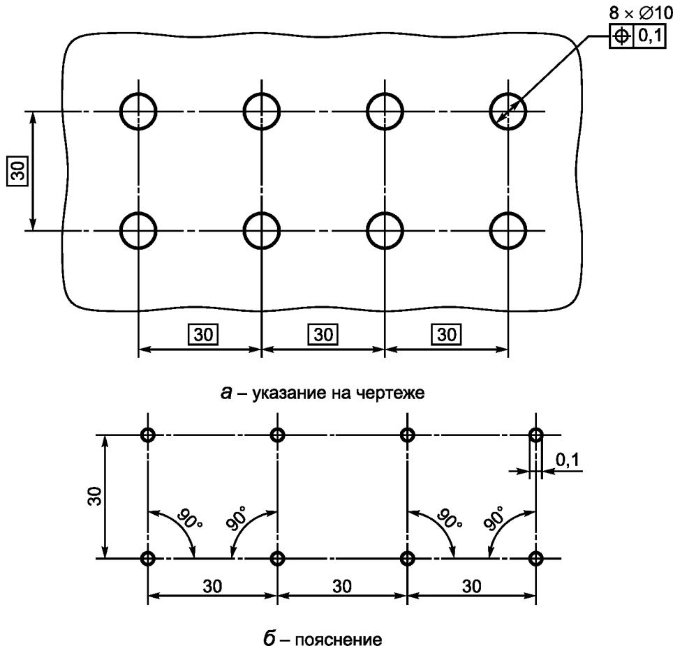
**П р и м е ч а н и е —** Выявленная средняя линия каждого отверстия не должна выходить за пределы цилиндрического поля допуска диаметром 0,1 мм; оси полей допусков жестко связаны теоретически точными размерами.
