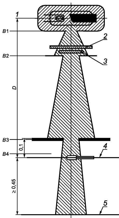
1 — диафрагмы пучка излучения ( $B_1$ ,  $B_2$ ,  $B_3$ ,  $B_4$ ); 2 — дополнительный фильтр; 3 — контрольный детектор ( $R_1$ ); 4 — измерительный детектор ( $R_2$ ); 5 — ширма из свинца;  $D$  — переменное расстояние
