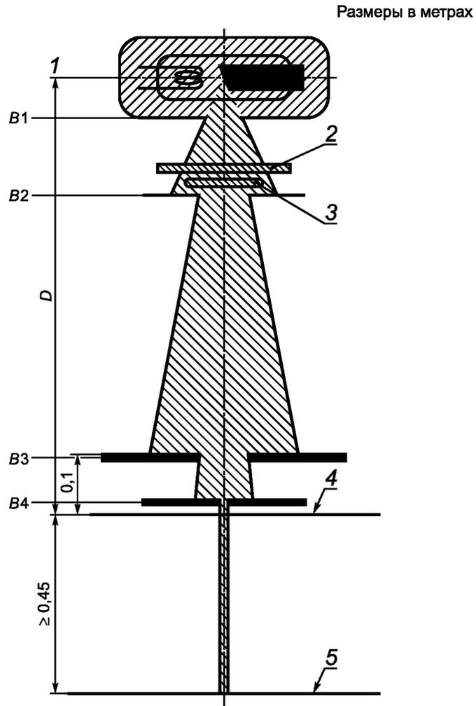
1 — диафрагмы пучка излучения ( $B_1$ ,  $B_2$ ,  $B_3$ ,  $B_4$ ); 2 — дополнительный фильтр; 3 — контрольный детектор ( $R_1$ );
