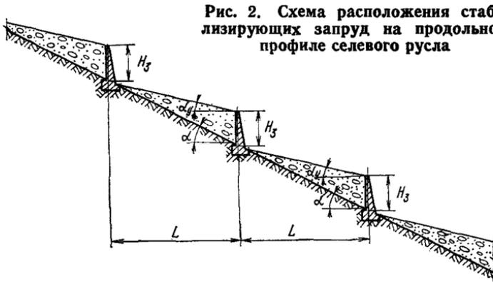
Рис. 2. Схема расположения стабилизирующих запруд на продольном профиле селевого русла
