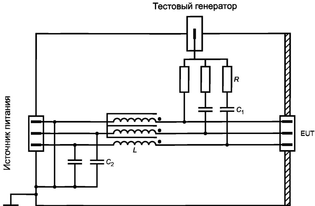
Примечание — CDN = M3,  $C_1$  (тип) = 10 нФ,  $C_2$  (тип) = 47 нФ,  $R = 300$  Ом,  $L \geq 280$  мкГн для 150 кГц; CDN = M2,  $C_1$  (тип) = 10 нФ,  $C_2$  (тип) = 47 нФ,  $R = 200$  Ом,  $L \geq 280$  мкГн для 150 кГц; CDN = M1,  $C_1$  (тип) = 22 нФ,  $C_2$  (тип) = 47 нФ,  $R = 100$  Ом,  $L \geq 280$  мкГн для 150 кГц.
