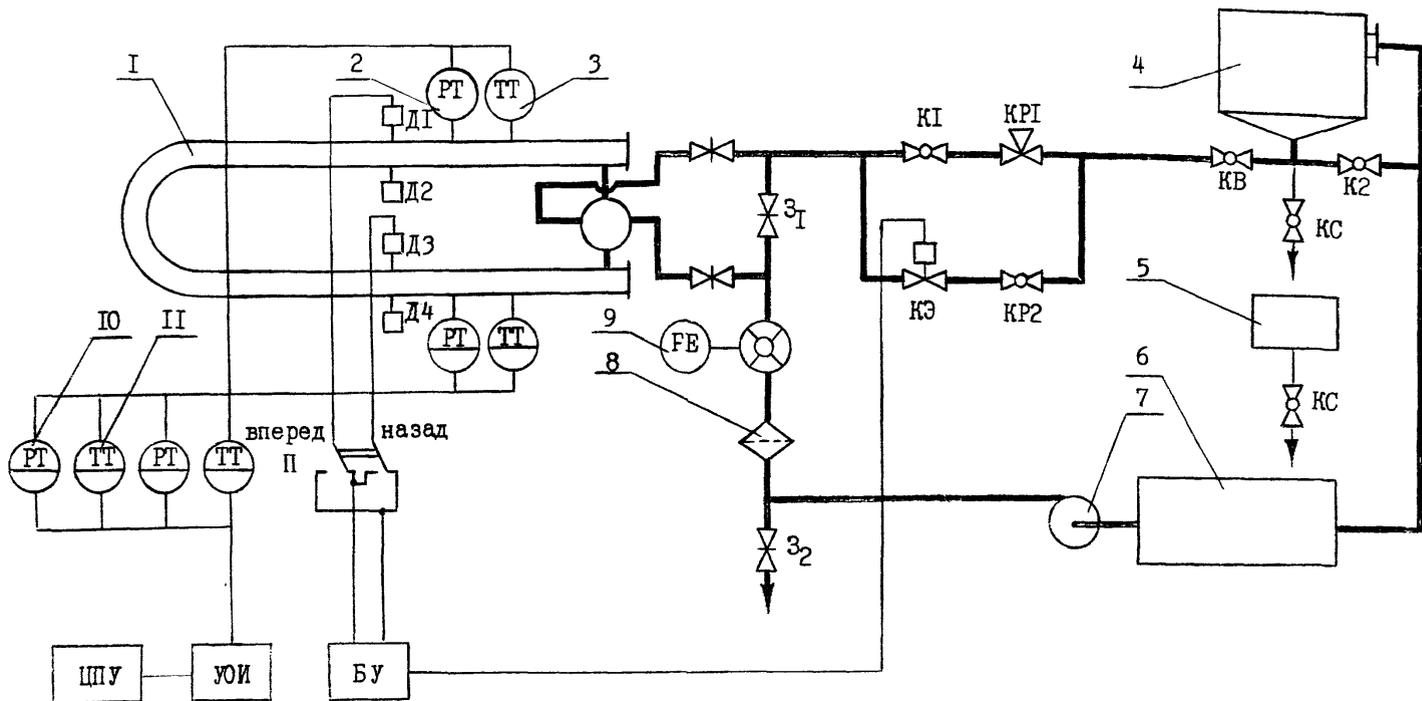
I - ТПУ; 2,3 - датчики давления и температуры; 4 - емкость накопительная; 5 - весы (мерник);
