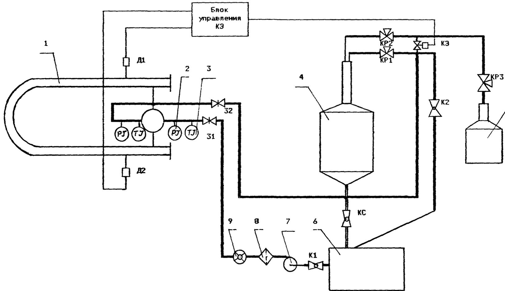
1 - ТПУ; 2 - нанометр; 3 - термометр; 4-5 - мерники;
