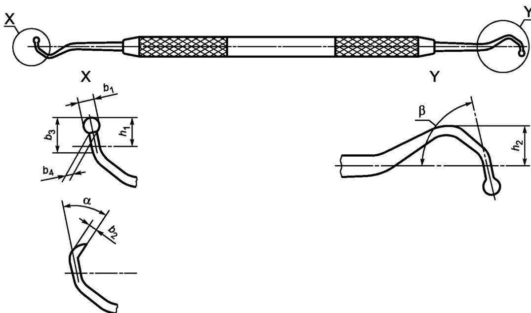
Рисунок 4 — Форма D: со сложным изгибом
