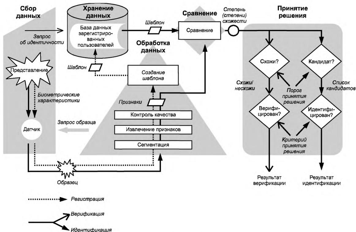
Рисунок 1 — Компоненты обобщенной биометрической системы
