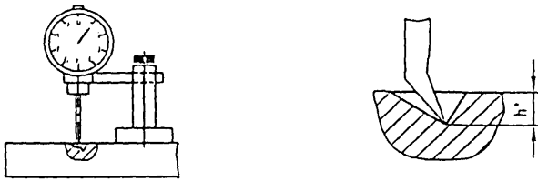
Рисунок Е.2 - Схема измерения глубины фрезерования сегмента
