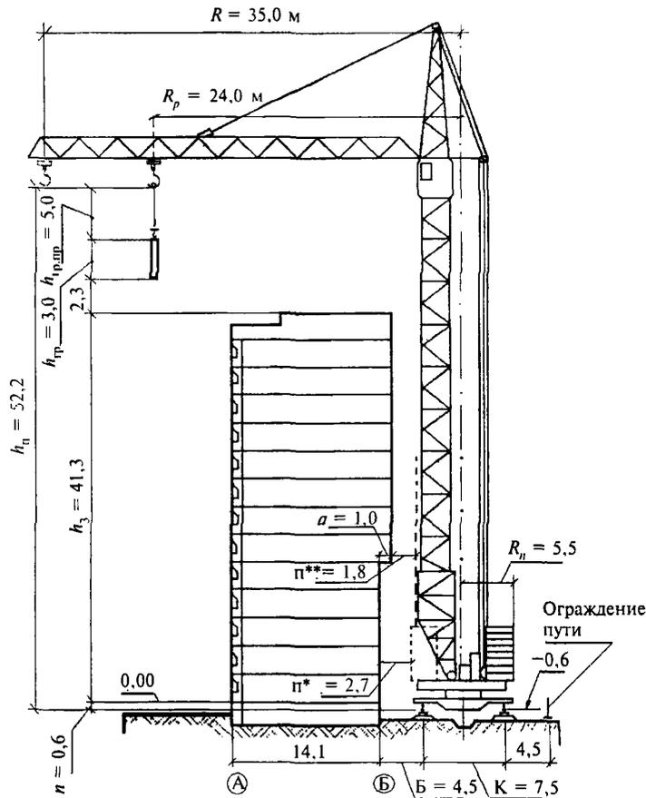
Рисунок 1 — Привязка башенного крана к зданию
