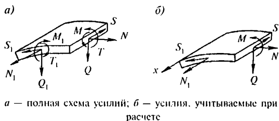
Рисунок 9.4 — Усилия, действующие в длинных цилиндрических оболочках и складках
