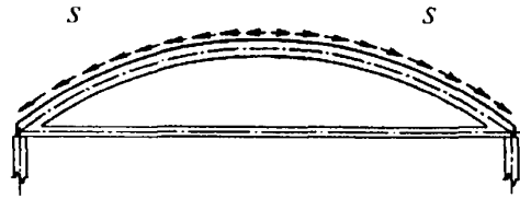
Рисунок 9.9 — Схема передачи усилий с оболочки на диафрагму
