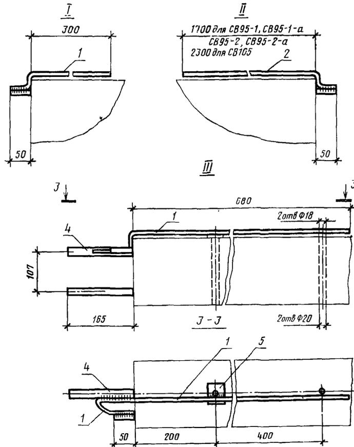
1—верхний заземляющий проводник; 2—нижний заземляющий проводник; 4—штырь;
