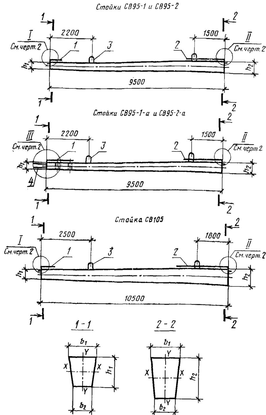
1—верхний заземляющий проводник; 2—нижний заземляющий проводник;
