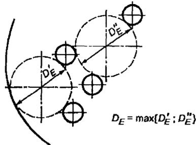
Рисунок 14 — Диаметр окружности, вписанной в максимальную беструбную площадь
