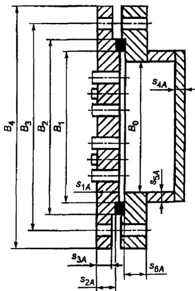
Рисунок 15 — Камера разъемной конструкции со сварной крышкой
