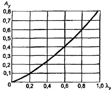
Рисунок 12 — Коэффициент для определения максимального прогиба трубы
