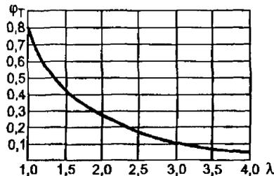
Рисунок 11 — коэффициент уменьшения допускаемого напряжения при продольном изгибе
