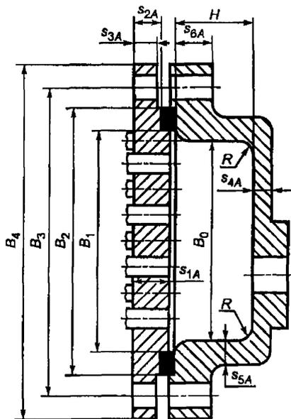
Рисунок 16 — Камера разъемной конструкции с литой крышкой
