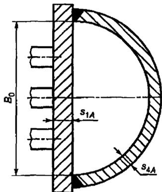
Рисунок 20 — Камера неразъемной конструкции с полуцилиндрической задней стенкой
