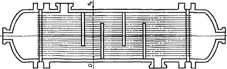
Рисунок 1 — Аппарат с неподвижными трубными решетками
