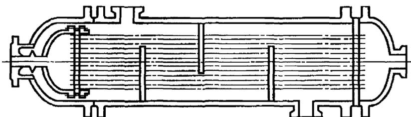
Рисунок 6 — Аппарат с компенсатором на плавающей головке
