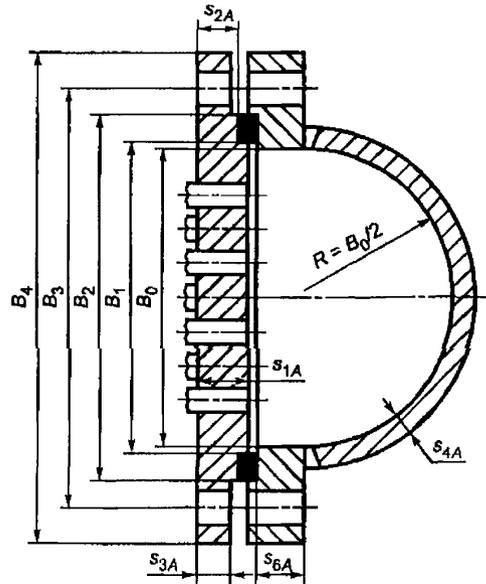
Рисунок 18 — Камера разъемной конструкции со сварной полуцилиндрической крышкой
