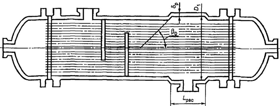
Рисунок 3 — Аппарат с расширителем на кожухе
