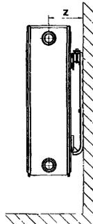
Рис. 6.2. Установка радиатора «VONOVA Компакт» на стене на кронштейнах-консолях «Vonomat»
