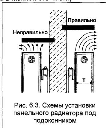
Рис. 6.3. Схемы установки панельного радиатора под подоконником
