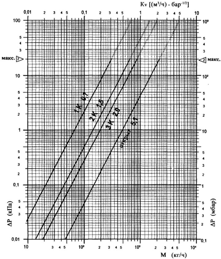
Рис. 3.2. Гидравлические характеристики термостатов «ГЕРЦ-TS-E» при различных режимах настройки
