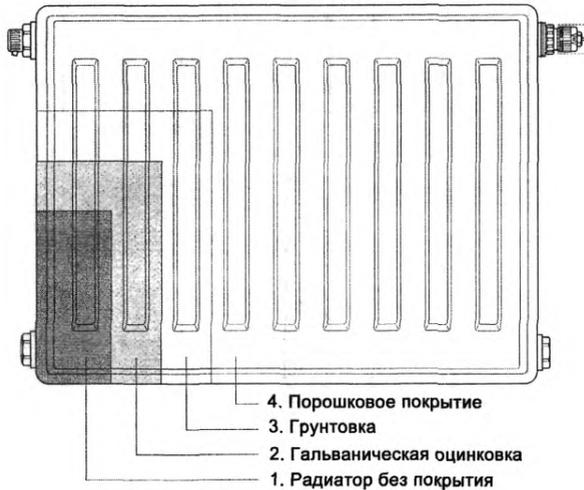
Рис. 1.3. Последовательность покрытия оцинкованных радиаторов «VONOVA»
