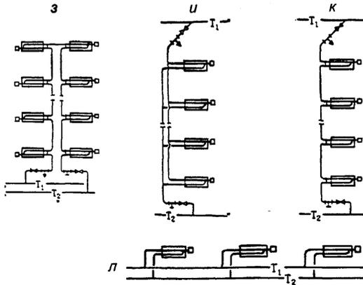
Рис. 3.1. Схемы присоединения конвекторов к системам водяного отопления
