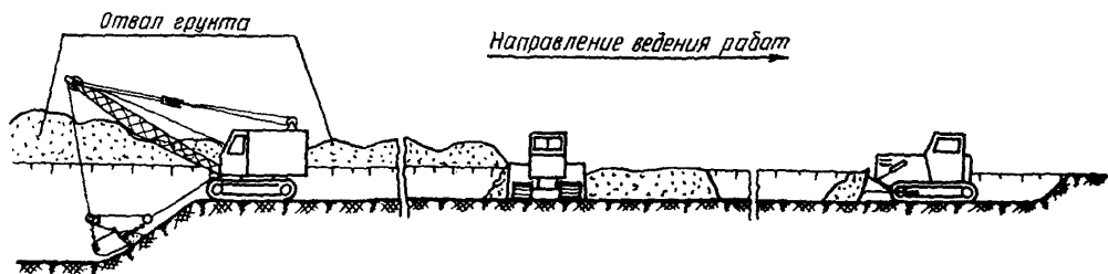
Рис.9. Разработка траншей в песчаных грунтах комбинированным способом
