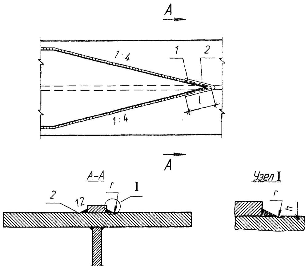
$l$  – граница углового шва; 2 – зона механической обработки;  $l$  – длина обрабатываемого участка шва ( $l \geq 100$  мм);  $r$  – радиус перехода ( $r \geq 3$  мм);  $h$  – величина ослабления сечения
