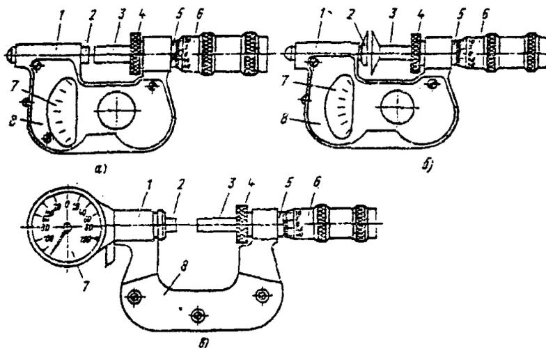
1 – скоба; 2 – подвижная пятка; 3 – микрометрический винт; 4 – стопор; 5 – стержень;
