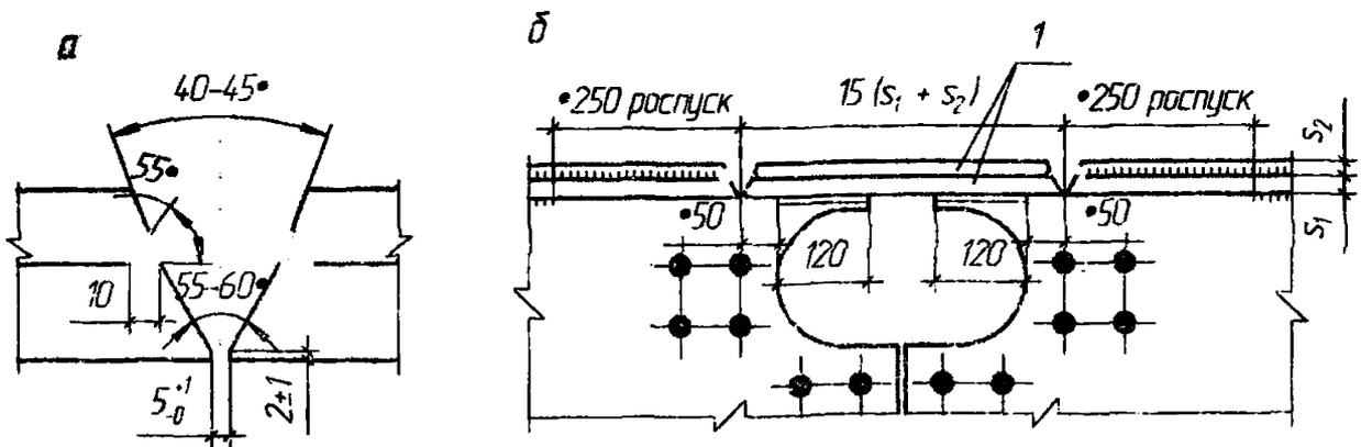
*а* – подготовка кромок стыка пакетного пояса; *б* – верхние пояса с разнесёнными стыками; *1* – пакетная монтажная вставка (на монтаж поставляется россыпью с припуском каждого листа)
