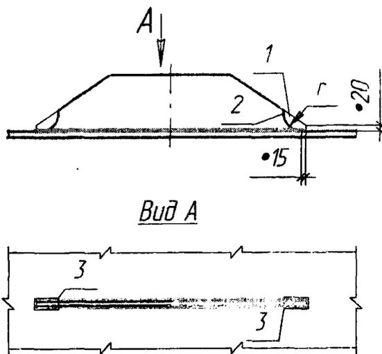
1 – технологический припуск; 2 – контур, по которому припуск удаляется газокислородной резкой;
