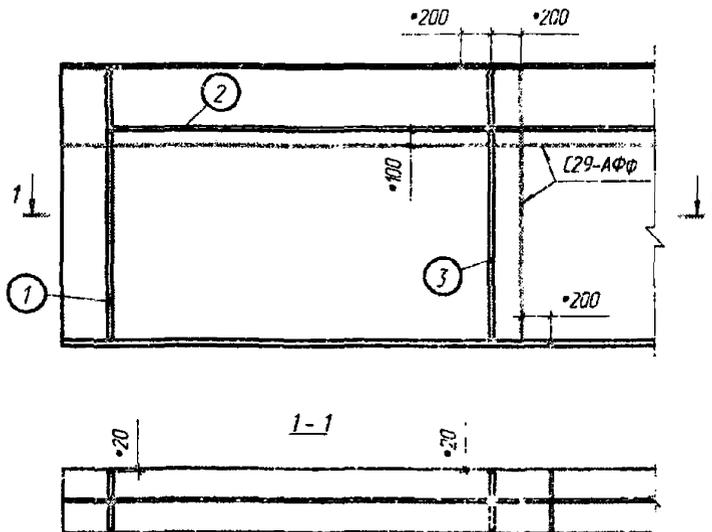
1 – опорное ребро; 2 – продольное ребро; 3 – поперечное ребро
