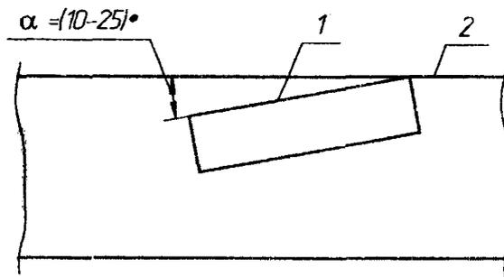
1 – плоскость шлифа; 2 – поверхность кромки после резки
