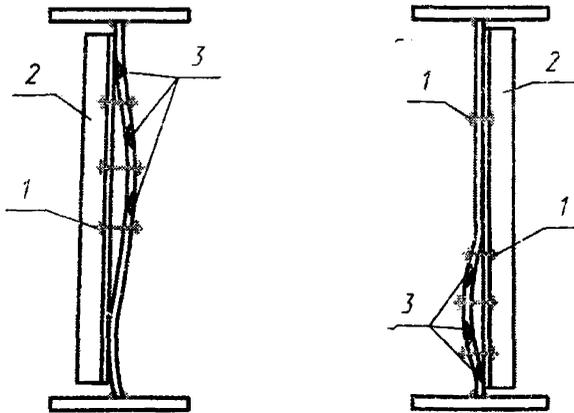
1 – струбцины; 2 – уголок жесткости 125Ч125Ч12; 3 – полосы нагрева металла
