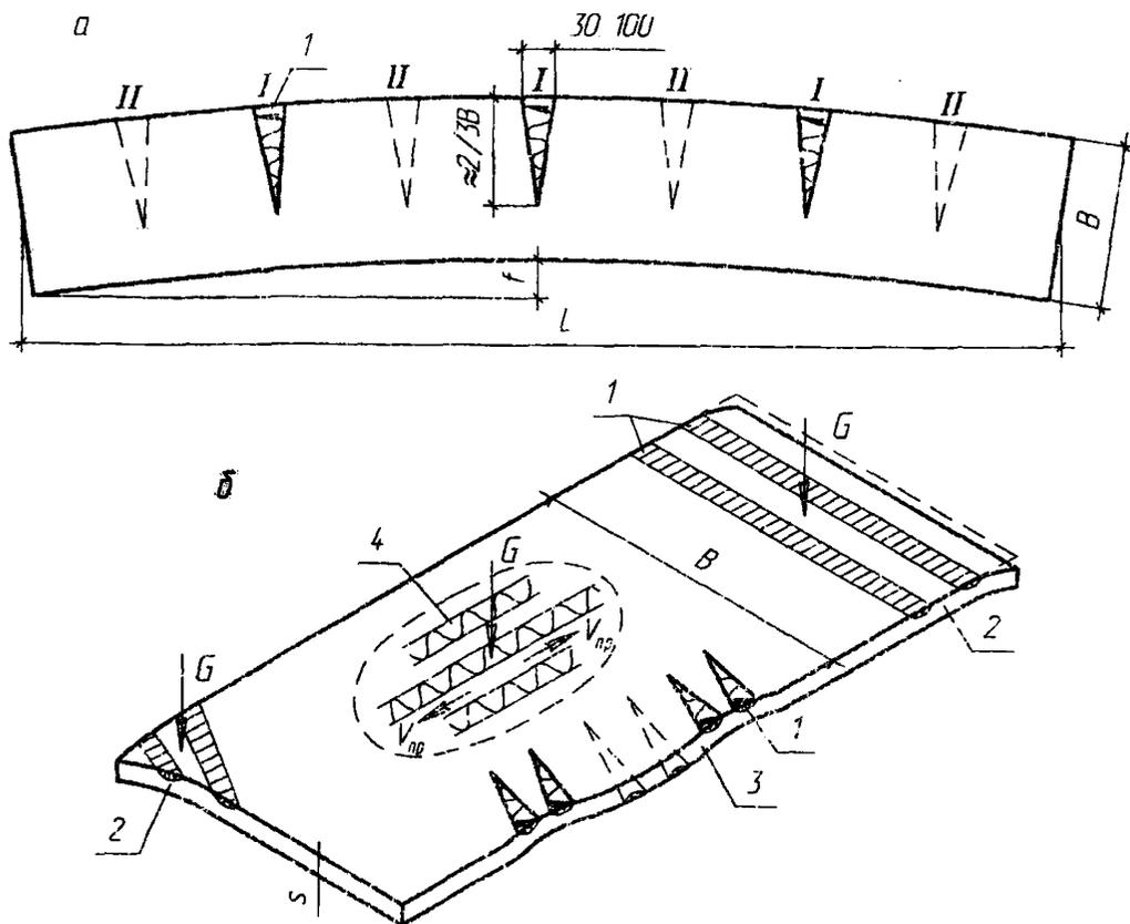
*a* – термическая правка саблевидности; *b* – термомеханическая правка волнистости «бахромы» по кромке, выпуклости («хлопуна»); *G* – статическая нагрузка (пригруз); *1* – зоны нагрева; *2* – волнистость; *3* – «бахрома» по кромке; *4* – выпуклость («хлопун»);  $V_{пр}$  – направление нагрева полос при правке «хлопуна» (от центра к краям)
