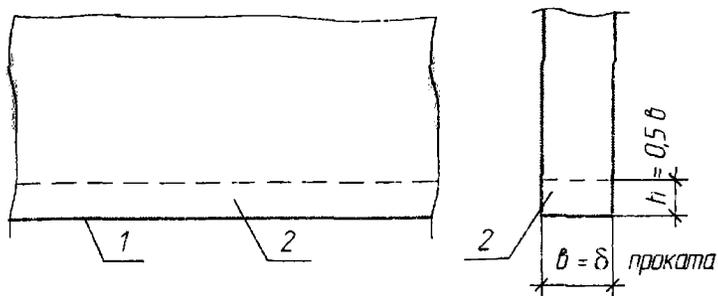
1 – поверхность кромки после резки; 2 – образец для испытаний на загиб
