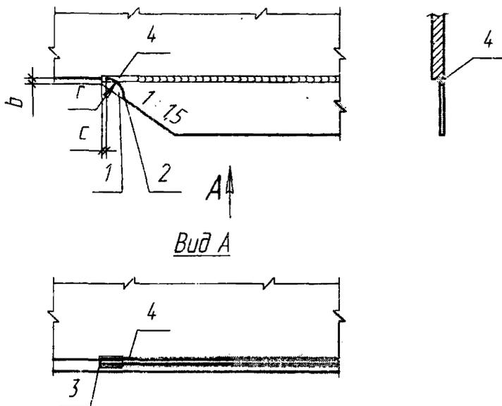
1 – технологический припуск; 2 – контур, по которому припуск удаляют газовой резкой;
