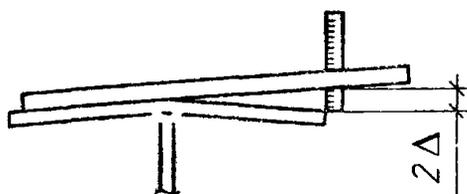
Рисунок 19 – Измерение симметричной грибовидности линейками
