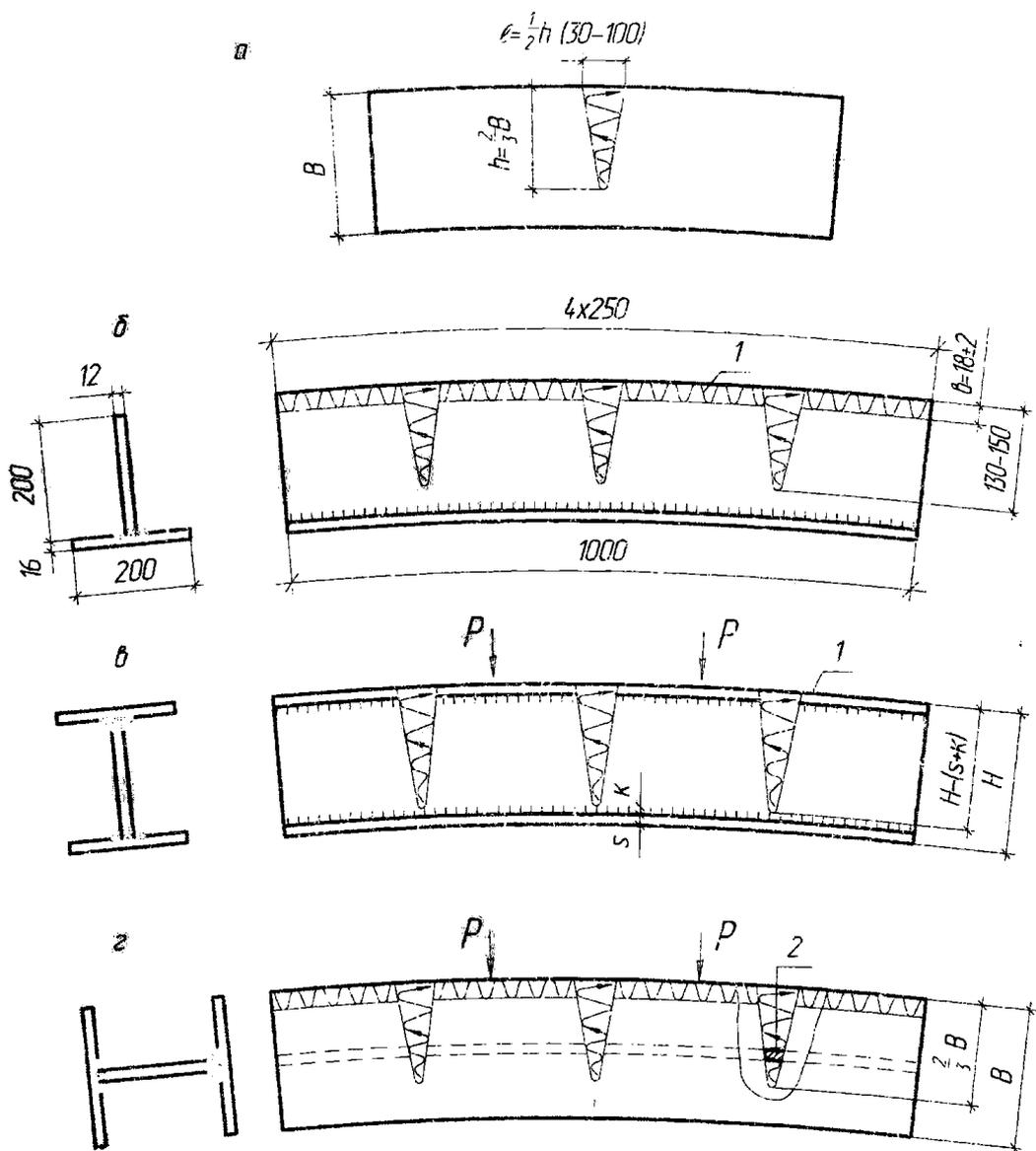
а – геометрическая форма и размеры «клина»; б – термическая правка тавра;
