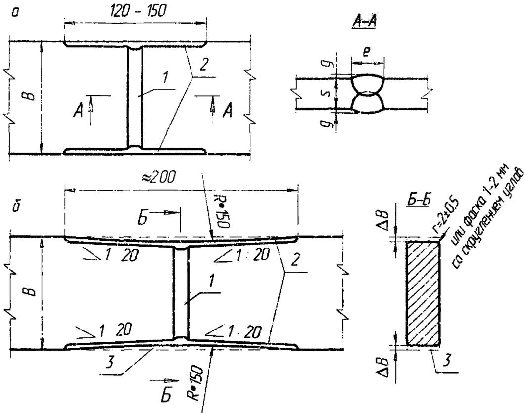
а – схема обработки без углубления в основной металл по кромкам;
