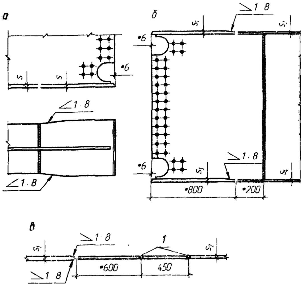
*а* – уширение пояса; *б* – утолщение поясов наружу (верх) и внутрь (низ); *в* – утолщение стенки сплошнотенчатой балки; *1* – монтажные сварные стыки стенки
