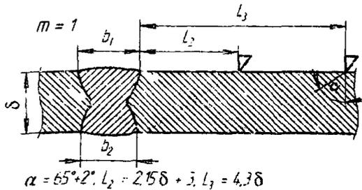
Примечания 1 Контроль подлежат соединения при условии, что  $b_1 + b_2 \leq 4,38 - 3\delta$ ;
