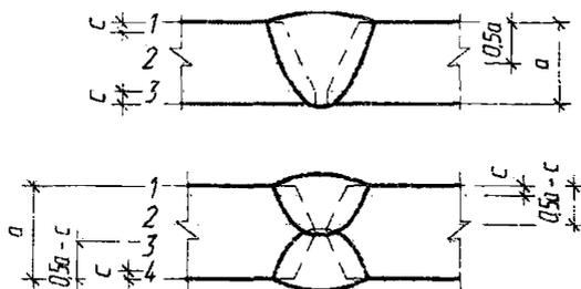
$a$  – толщина основного металла, мм;  $c$  – от 2 до 4 мм.
