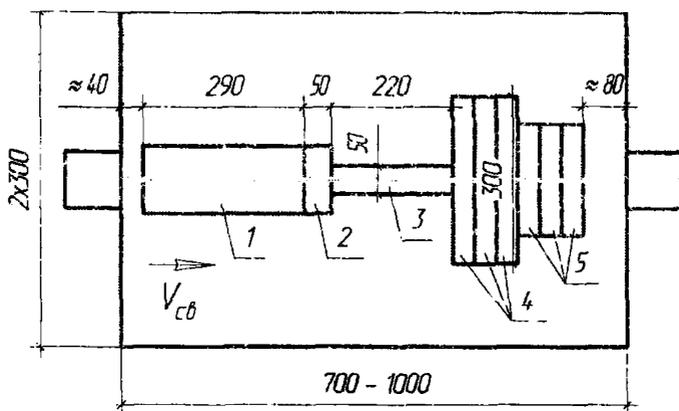
1 – образцы на ударный изгиб; 2 – макрошлифы; 3 – цилиндрические образцы;
