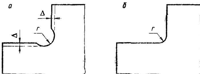
а – вырезы, образованные сверлением и штамповкой, а также сверлением и машинной кислородной, плазменно-дуговой и лазерной резкой;  $\Delta$  – зона обработки при применении штамповки ( $\Delta = 2 \dots 4$  мм); б – вырезы, образованные машинной кислородной, плазменно-дуговой и лазерной резкой
