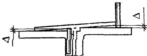
Рисунок 20 – Измерение перекоса двумя угольниками и линейками
