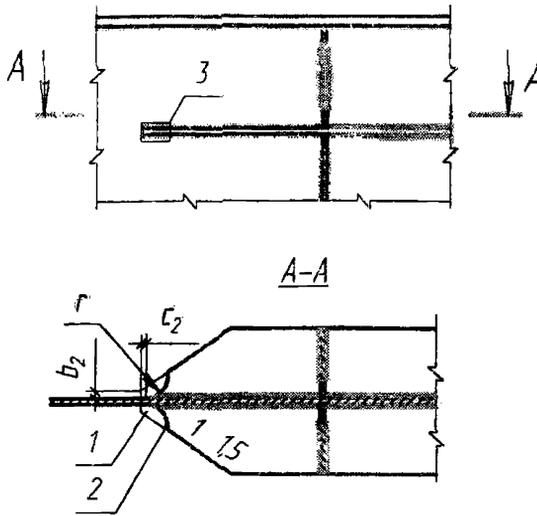
1 – технологический припуск; 2 – контур, по которому припуск удаляют газовой резкой;
