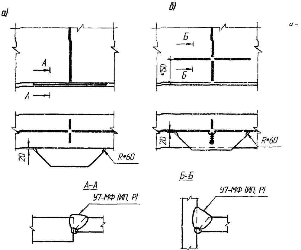
крепление к поясу главной балки; б – крепление к стенке главной балки
