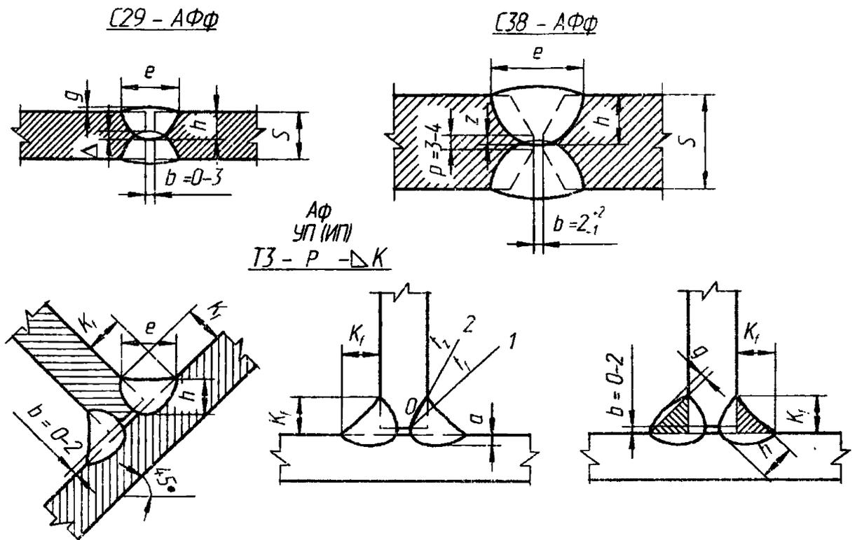
$h$  – глубина проплавления;  $P$  – притупление;  $z$  – глубина проплавления притупления;
