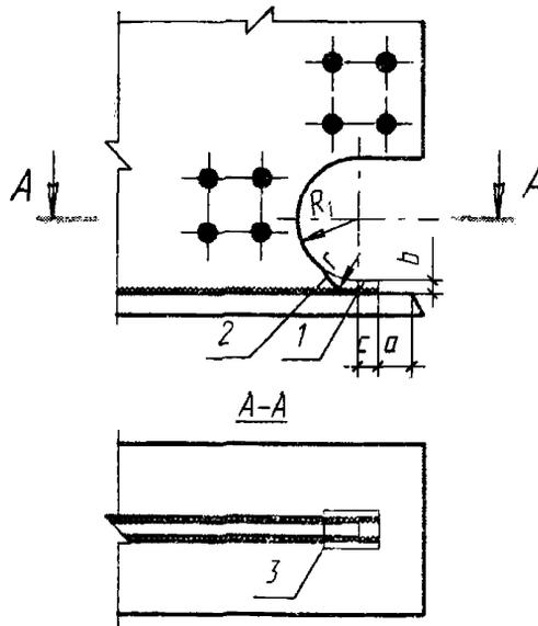
1 – технологический припуск; 2 – контур, по которому припуск удаляют газовой резкой;
