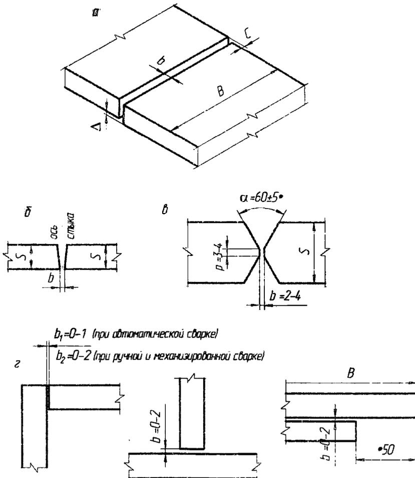
Соединения: а – стыковое; б – стыковое с неперпендикулярными кромками; в – стыковое с Х-образной разделкой кромок; г – угловое, тавровое, нахлесточное;
