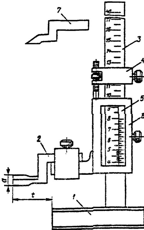
1 – основание; 2 – измерительная ножка; 3 – штанга; 4 – микрометрическая подача;
