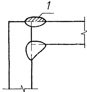
$r$  – снятие усиления шва;  $r$  – радиус обработки ( $r \geq 60$ );
