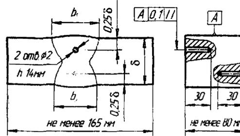
Изготавливается из материала контролируемого соединения
