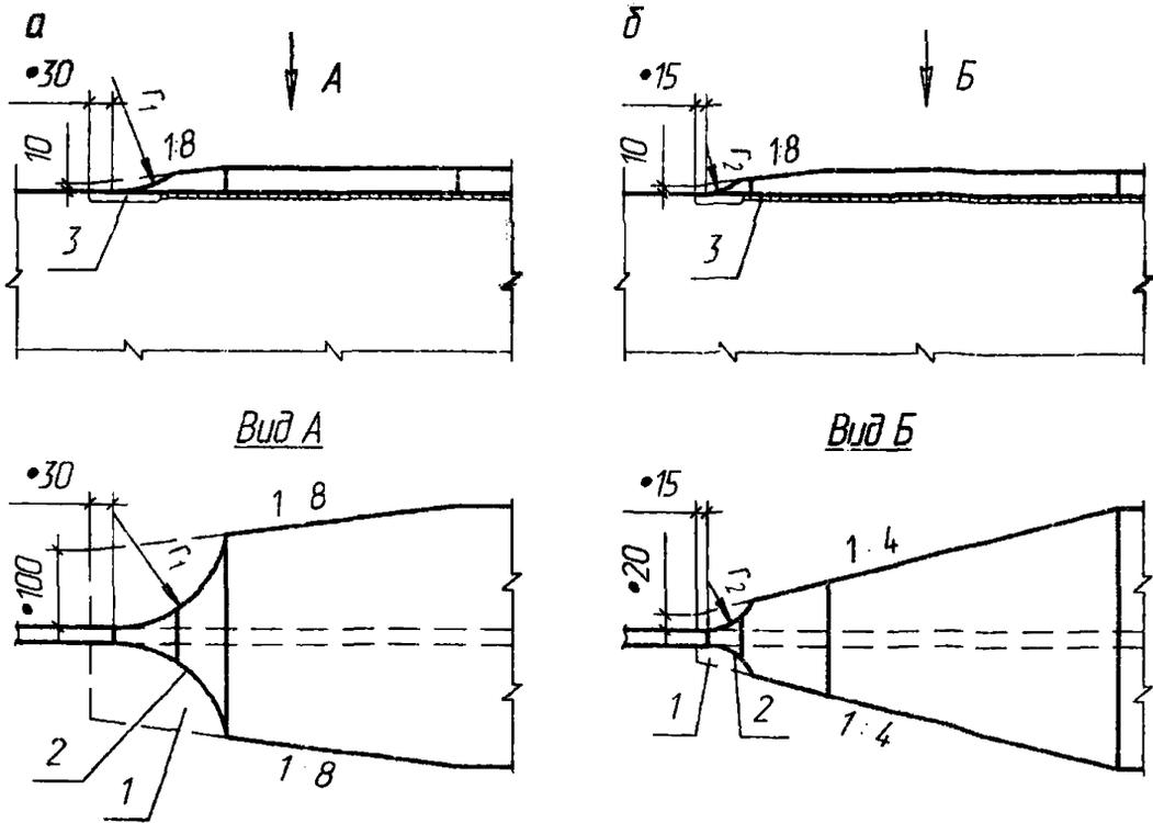
а – вариант для растянутых элементов; б – вариант для сжатых элементов;
