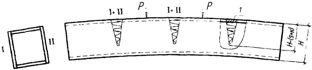
I; II - одновременно работающие горелки в каждом сечении;
