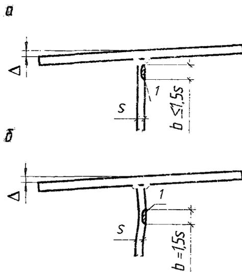
*a* – элемент с прямой стенкой; *b* – элемент с искривлённой стенкой;
