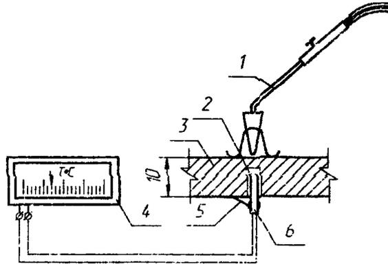
1 – горелка; 2 – притёртый медный «пятячок»; 3 – стальная пластина; 4 – прибор, регистрирующий температуру; 5 – прижим; 6 – термопара, заключённая в трубку с двумя отверстиями
