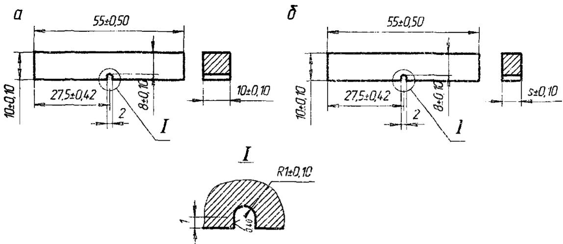
$a$  – образец для металла шва толщиной 10 мм и более;
