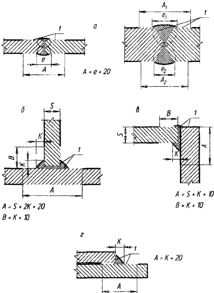
Соединения: а – стыковые; б – тавровые; в – угловые; г – нахлесточные;
