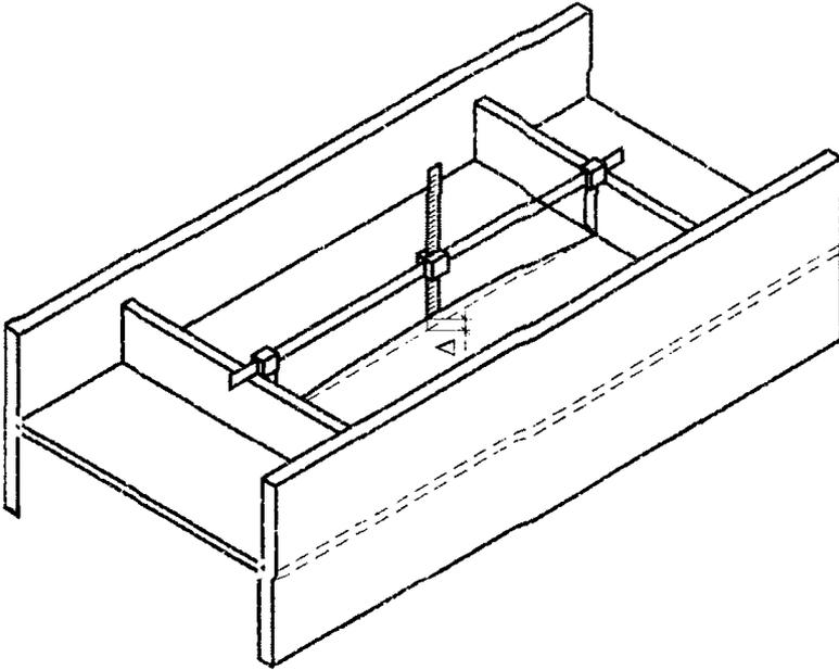
Рисунок 22 – Измерение выпучивания («хлопуна») в замкнутом контуре
