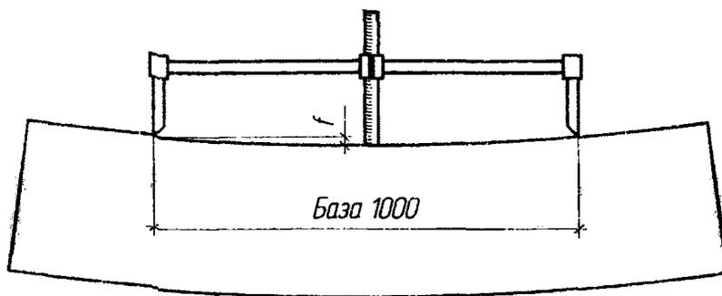
Рисунок 21 – Измерение саблевидности на базе 1 м
