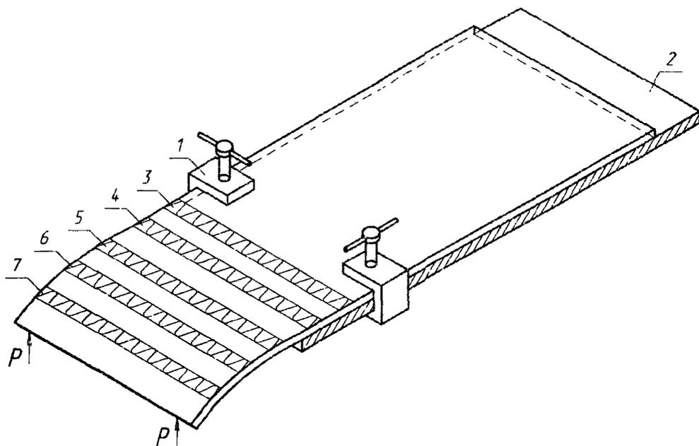
1 – струбцины; 2 – стол (стенд); 3–7 – полосы нагрева металла; P – нагрузки (усилия домкратов)
