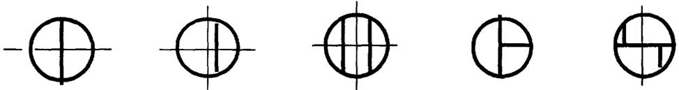
Рисунок 5.1 - Расположение сварных швов заготовок выпуклых днищ
