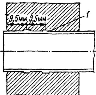
1 - канавки шириной 3,5 мм и глубиной 0,5 мм
