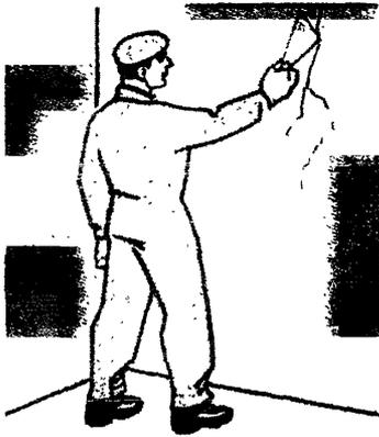
Рисунок 2 – Расшивка трещины
