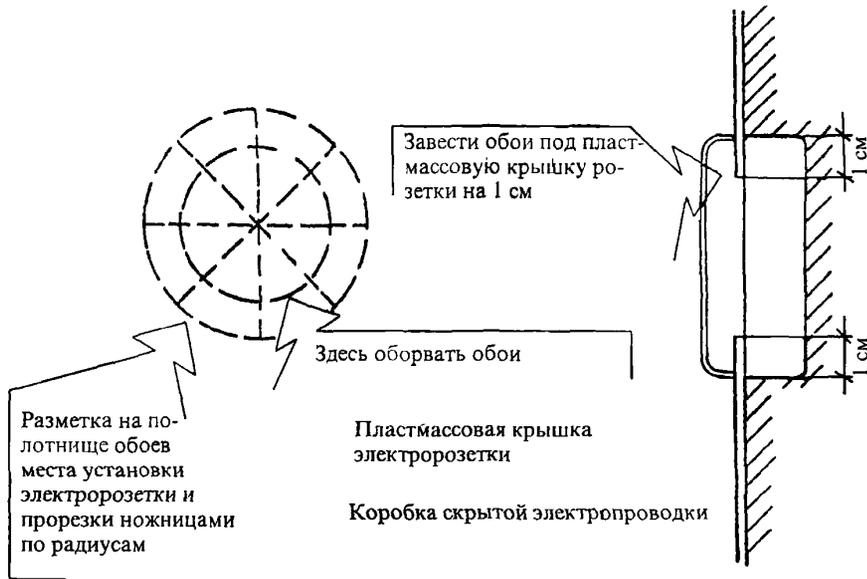
**Рисунок 17 – Обработка мест примыкания обоев к электророзеткам**
