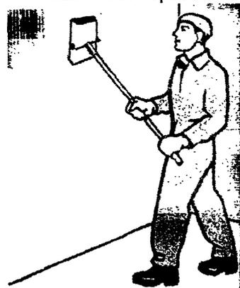
Рисунок 7 – Шлифовка поверхности стен шарнирными терками
