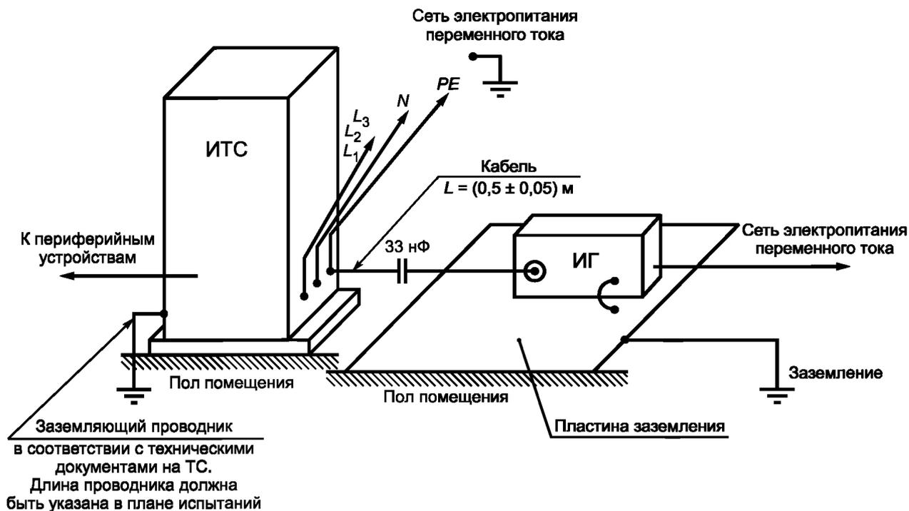
$L_1, L_2, L_3$  — фазные провода;  $N$  — нейтральный провод;  $PE$  — защитное заземление
