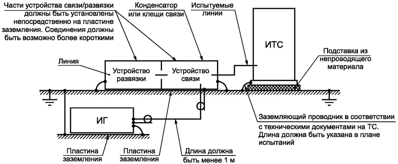
Рисунок 6 — Схема испытаний ТС на устойчивость к НИП
