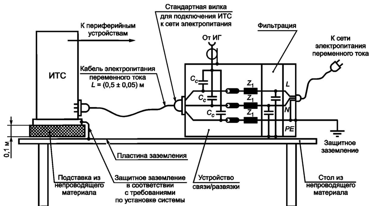
$L_1, L_2, L_3$  — фазные провода;  $N$  — нейтральный провод;  $PE$  — защитное заземление;  $Z_1$  — индуктивность развязки;  $C_c$  — конденсатор связи
