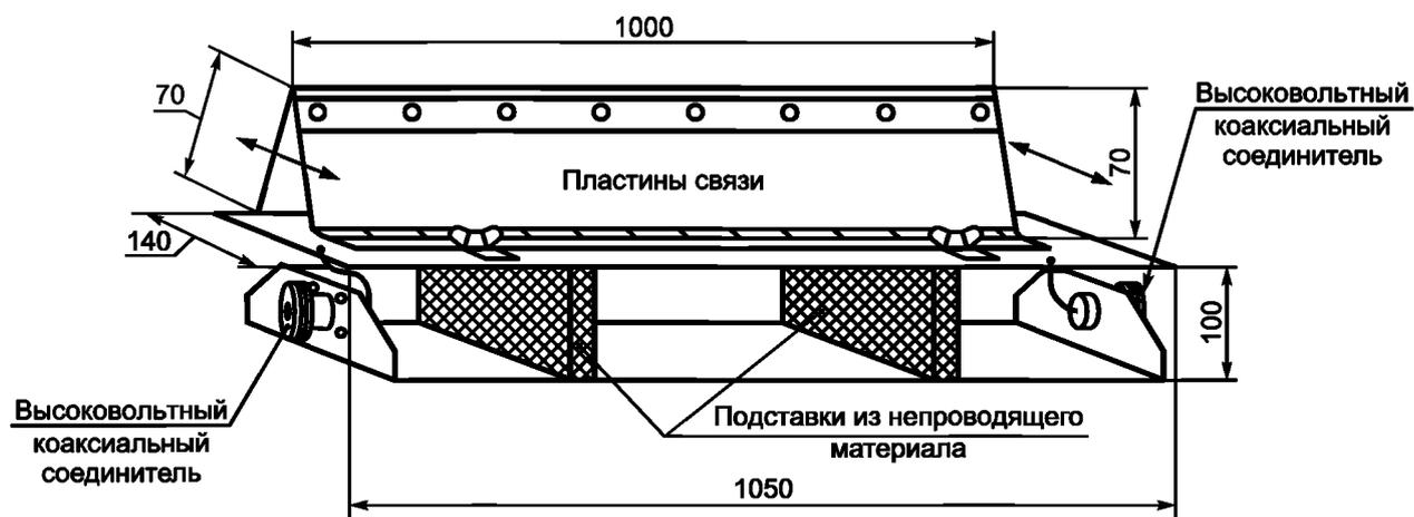
Примечание — Минимальное расстояние между пластинами связи и любыми другими проводящими конструкциями, за исключением испытуемого кабеля и пластины заземления, должно быть 0,5 м.
