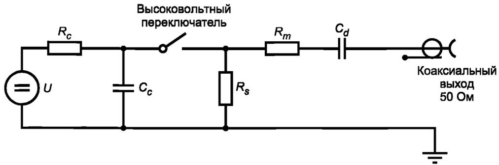
$U$  — источник высокого напряжения;  $R_c$  — зарядный резистор;  $C_c$  — накопительный конденсатор;  $R_s$  — резистор цепи формирования длительности импульса;  $R_m$  — согласующий резистор;  $C_d$  — разделительный конденсатор
