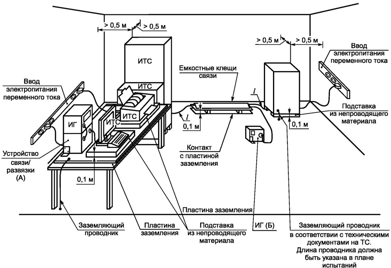
А — размещение устройства связи/развязки для подачи НИП на линии электропитания; Б — размещение ИГ для подачи НИП на сигнальные линии
