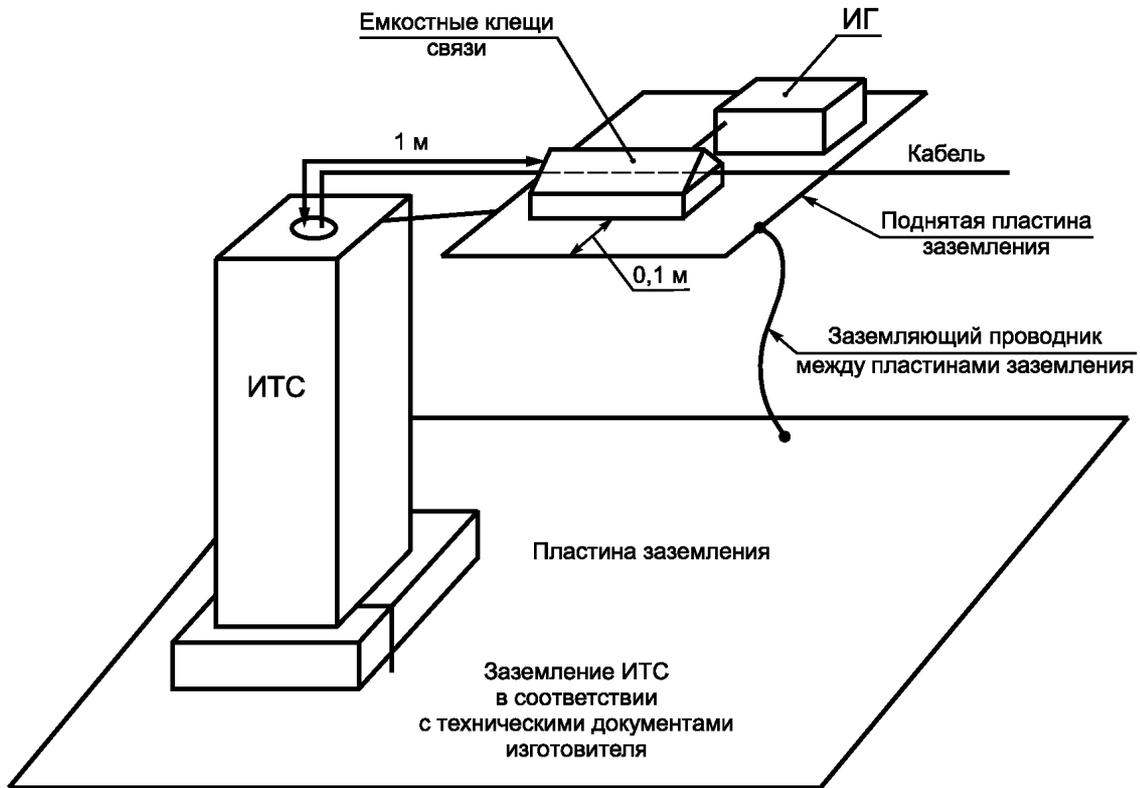
П р и м е ч а н и е — Допускается установка емкостных клещей связи на стене экранированного помещения или на другой заземленной поверхности. Емкостные клещи связи соединяют с корпусом ИТС. При испытаниях напольных ИТС значительных размеров с кабелями, выводимыми наверх, допускается установка клещей связи на высоте 10 см над центром ИТС. При этом кабели, подключаемые к емкостным клещам связи, пропускают через центр пластины заземления клещей.
