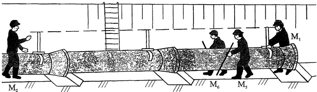
**Рисунок 12 – Схема проверки правильности укладки трубы**
