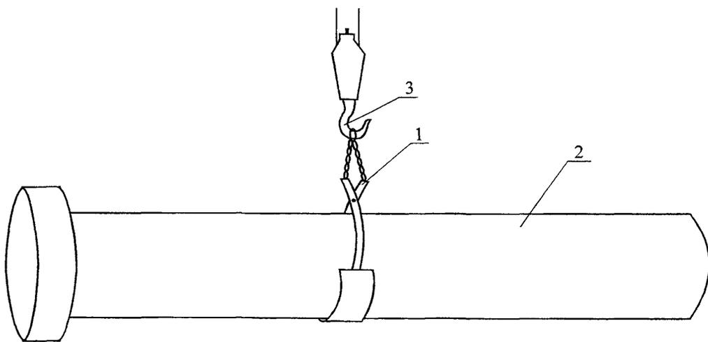
1 – клещевой захват; 2 – труба; 3 – гак подъемного механизма
