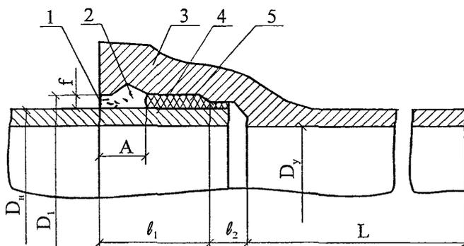
1 – битумная мастика; 2 – асбестоцементный замок глубиной А; 3 – раструб; 4 – гладкий конец трубы; 5 – уплотнительная пряжа.
