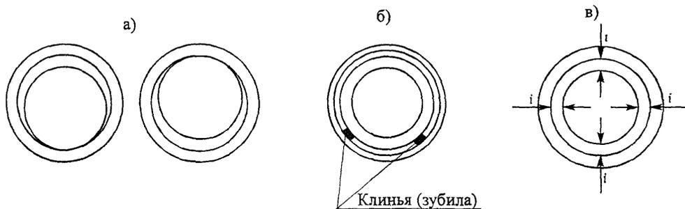
а) положение трубы в раструбе до центрирования; б) подкладка зубил для центрирования; в) конечное положение трубы в раструбе при правильном центрировании,  $i$  – величина кольцевого зазора
