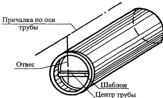
**Рисунок 9 – Центровка труб со стороны раструба**
